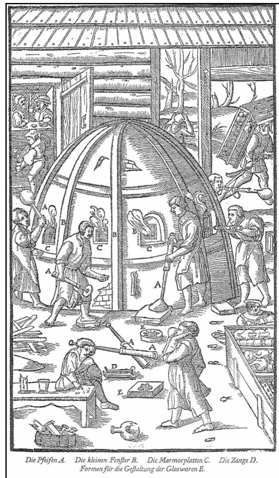
Abbildung 17: Dritter Glasofen zur Herstellung fertiger Glaswaren (AGRICOLA 1556)
