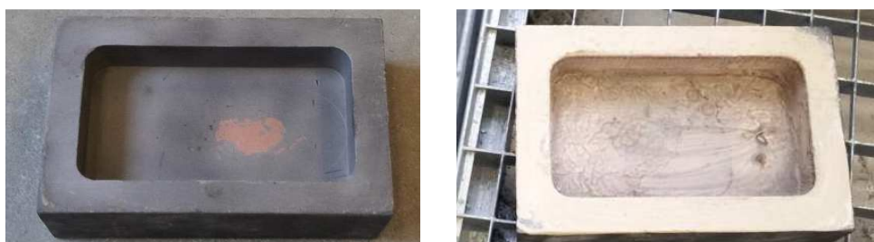
Abbildung 5-7: Darstellung der sandgestrahlten Stahlkokille, rechts geschlichtet
