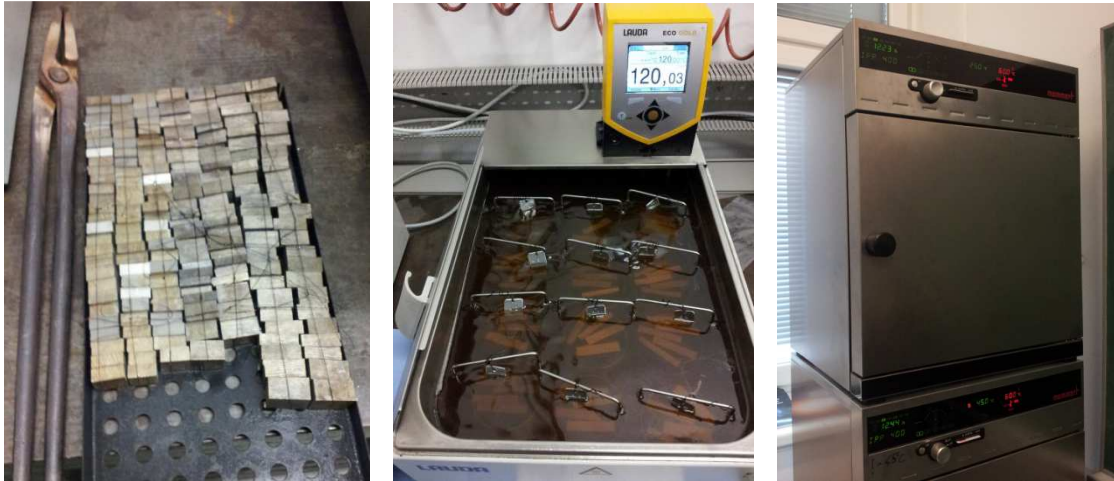
Abbildung 5-14: Würfelpföben für Auslagerungsversuche (links), direkt nach dem Lösungsglühen ergeben sich leichte Anlassfarben, anschließend erfolgt separate Auslagerung bei 120 °C im Ölbad oder bei 25 °C im Wärmeschrank (mittleres/rechtes Bild)
