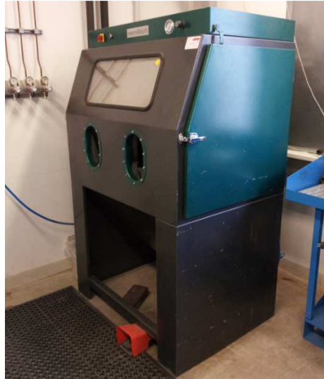
Abbildung 5-21: Sandstrahlkabine arbeitet mit Druckluft und entsprechender Druckluftpistole für Strahlmitteltransport
