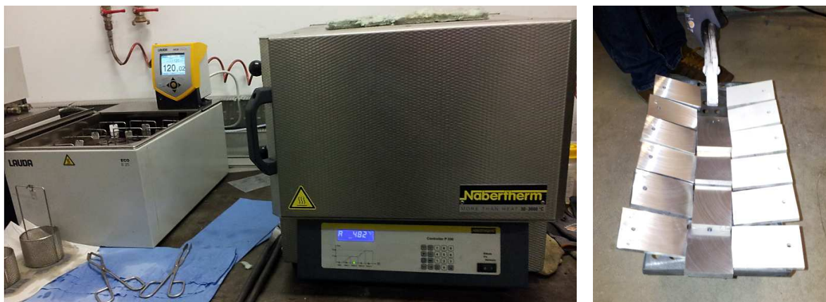
Abbildung 5-16: Ölbad LAUDA ECO und Nabertherm Umluft-Kammerofen nebeneinander (links), geschichtete Probenplatten (geschliffen/gestrahlt) kurz vor Einsatz in entsprechenden Ofen (rechts)
