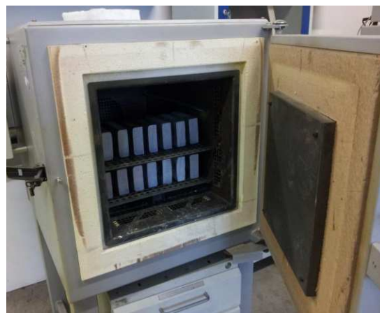
Abbildung 5-9: Nabertherm Umluft-Kammerofen bis 650 °C, verwendet für das Homogenisierungsglügen in zwei Stufen, zu behandelnde Legierungsblöcke im rechten Bild aufgereiht (geöffneter Ofen)
