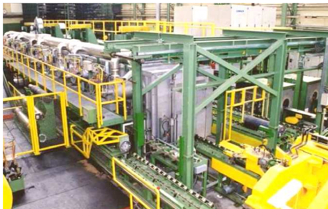
Abbildung 3-11: Konvektionsofen „Bauart OTTO JUNKER“, verschiedene Regelzonen für Stufenbehandlungen vorhanden [26]
