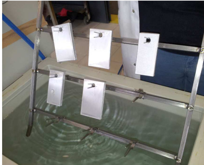
Abbildung 5-17: Probengestell aus Titan mit testweiser Belegung der Kontaktstellen (Klammermechanismus)
