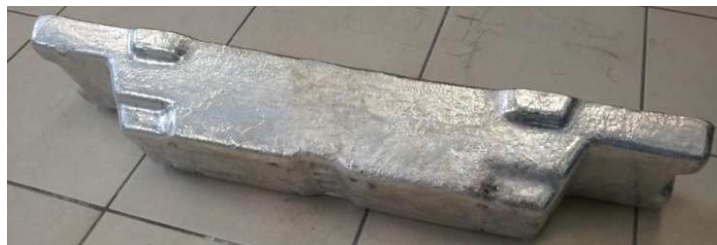
Abbildung 5-4: Reiner Aluminiumblock als Ausgangsmaterial für Legierungen, Masse um die 21 kg, chemische Durchschnittszusammensetzung in Tabelle 5-3
