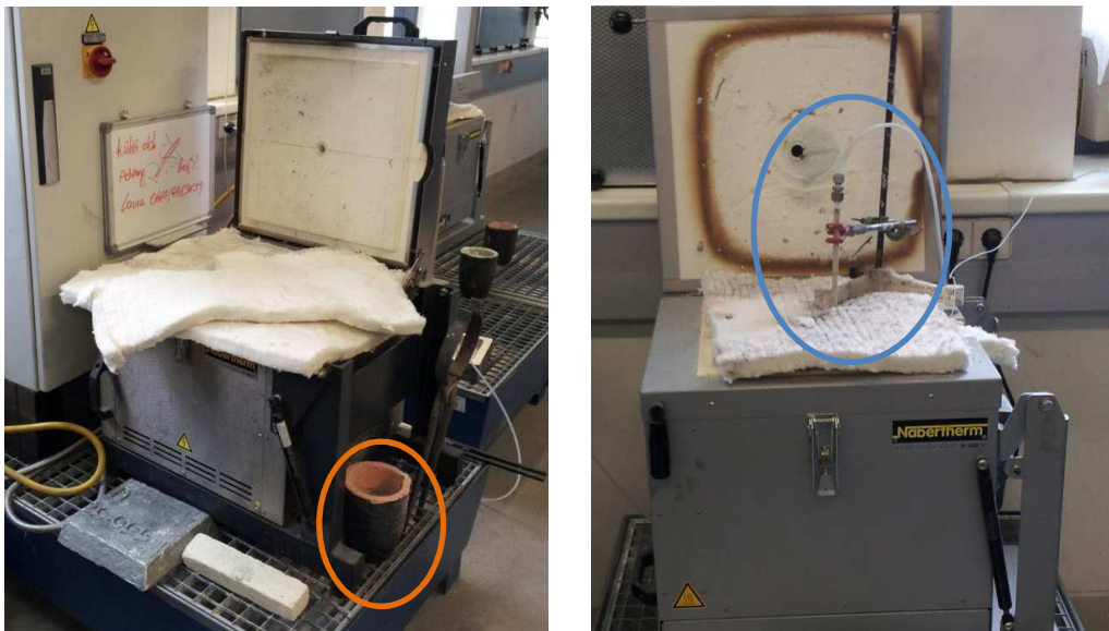
Abbildung 5-6: Verwendete Schmelzöfen der Marke „Nabertherm“, bis 1000 °C und für 1 Liter-Tiegel, abgedeckt mit weißen Feuerfest-Matten, geschlichteter Schmelztiegel neben dem Ofen (oranger Kreis, linkes Bild), Spülgasvorrichtung (blauer Kreis, rechtes Bild)
