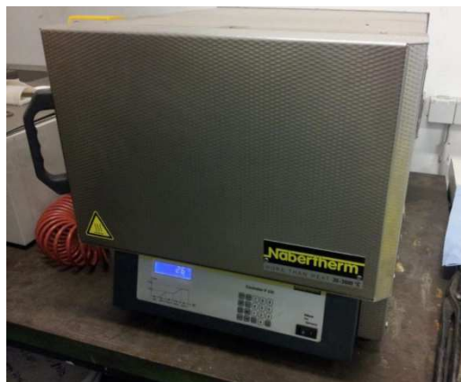
Abbildung 5-13: Kleiner Nabertherm Umluft-Kammerofen (bis 650 °C), verwendet zum Lösungsglühen aller weiteren Proben bei etwa 480 °C
