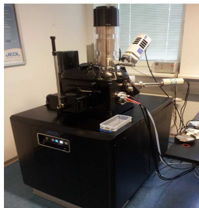
Abbildung 6-15: Rasterelektronenmikroskop der Firma JEOL Ltd. mit integrierter EDX-Einheit für chemische Analysen
