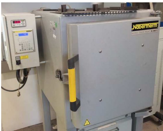
Abbildung 5-9: Nabertherm Umluft-Kammerofen bis 650 °C, verwendet für das Homogenisierungsglügen in zwei Stufen, zu behandelnde Legierungsblöcke im rechten Bild aufgereiht (geöffneter Ofen)
