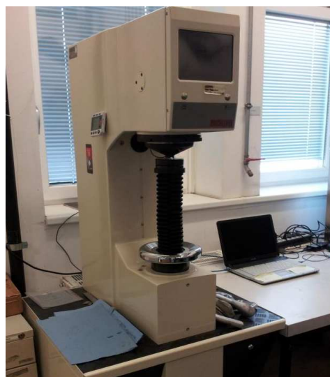
Abbildung 5-15: EMCO Universalhärteprüfgerät „M4C 025 G3M“ zum Erzeugen von Härteeindrücken nach dem Brinell-Verfahren
