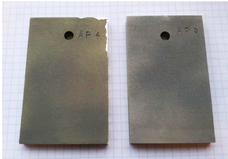
Abbildung 6-6: AMAG-Proben AP4 und AP5 (sandgestrahlt, siehe Tabelle 6-2) mit fleckiger Optik, leichte Abplatzungen bei AP4 (rechts oben) zusätzlich problematisch
