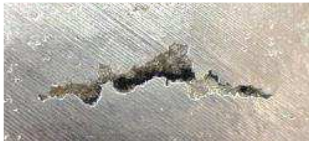
Abbildung 2-16: Schrumpfungsrisse mit 2 cm Länge, wie er auch zum Teil bei industriellen Versuchen vorkommt [20]
