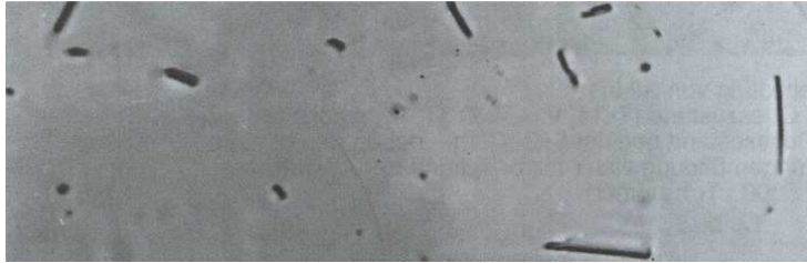
Abbildung 2-12: \text{Al}_3\text{Fe} -Nadeln in Aluminiummatrix, entstanden durch Glühung eines Al99,5-Blechs bei ca. 600 °C, Vergrößerungsfaktor etwa 800:1 [1]
