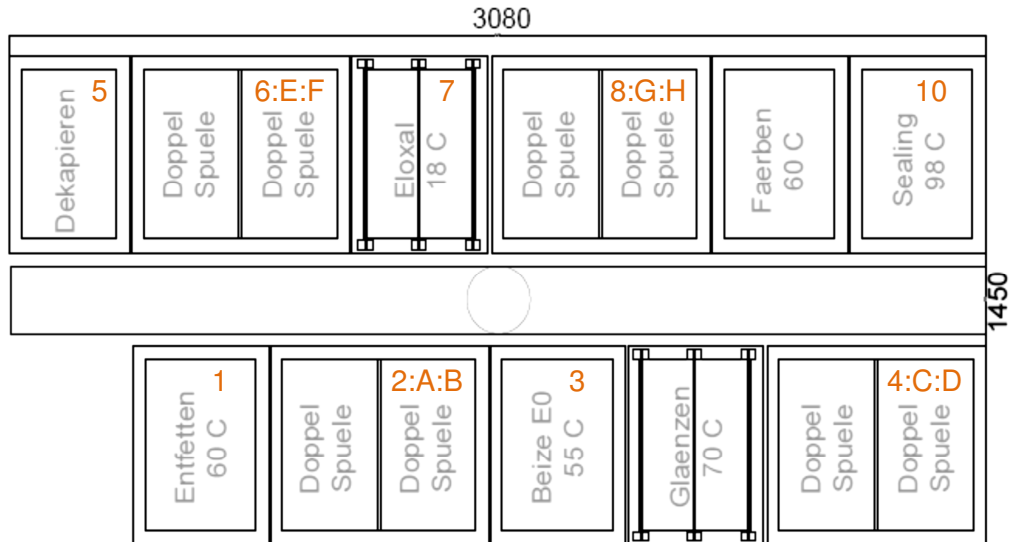
Abbildung 5-19: Anlagengrundriss mit schematischer Beschreibung aller Behandlungsbecken
