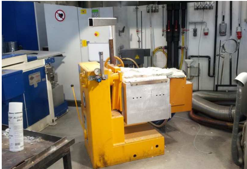
Abbildung 5-5: Induktionsofen zur Produktion einer mit Verunreinigungen (Si, Cr und Ti) einheitlich kontaminierten Vorlegierung für spätere Legierungsherstellung in Nabertherm-Öfen
