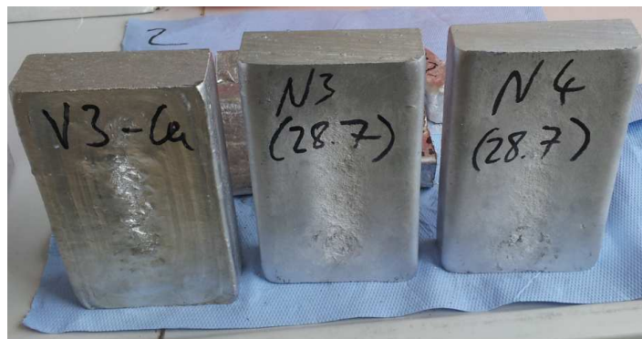
Abbildung 6 21: Abgegossene Barren mit teilweise einfallender Oberflächenstruktur, chemische Analyse durch Funkenspektroskopie der abgetrennten Probenenden
