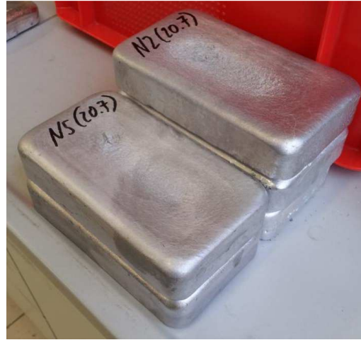
Abbildung 5-8: Stickstoffflanze zum Verhindern von Metallabbrand (links, Einbau unter Abbildung 5-6, blaue Markierung), fertige Legierungsblöcke vor Homogenisierungsglügen und Zuschnitt (rechts)
