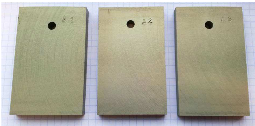
Abbildung 6-4: AMAG-Proben A1 bis A3 mit unterschiedlichen Gefügezustand (siehe Tabelle 6-2) und nach einheitlicher Eloxierung, leichter Gelbstich mit abweichender Intensität, A2 und A3 mit bester Optik
