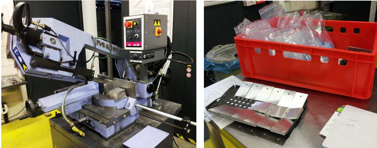
Abbildung 5-12: Stationäre Bandsäge Marke „Shark“, Modell 282 (links) mit Sägeblatt für Aluminium-Zuschnitt, fertig geschnittene und gebohrte Probenplatten im rechten Bild
