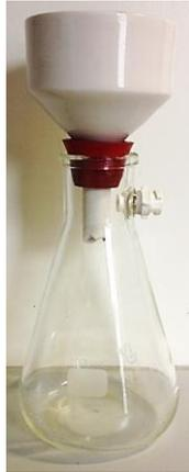
Abbildung 4-6: Keramiknutsche mit Papierfilter auf einer Saugflasche
