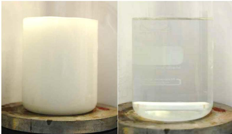
Abbildung 4-5: Herstellung des Fällungsmittels vor (l.) und nach der Auflösung (r.) der Oxalsäure
