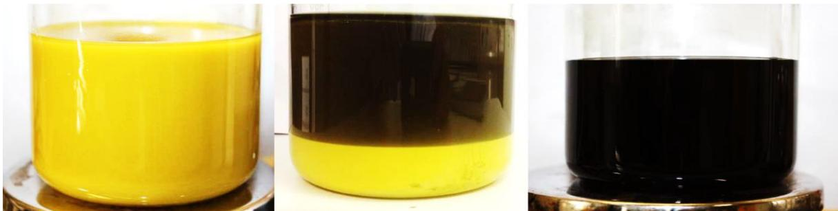
Abbildung 5-14: Lösungen aus der Fe-Ni-Co-Fällung vor, unmittelbar vor (ohne Rührung) und nach der Filtration (v.l.n.r)
