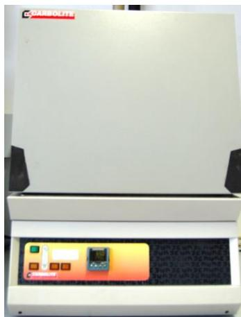
Abbildung 4-7: Veraschungssofen zur Kalzinierung der Rückstände
