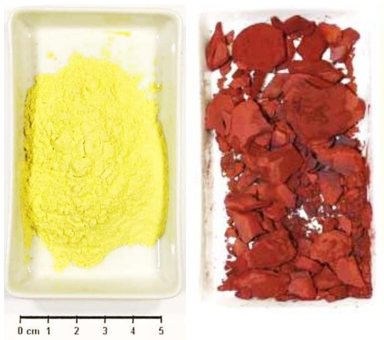
Abbildung 5-16: Getrockneter und kalzinierter Fe-Ni-Co-Rückstand
