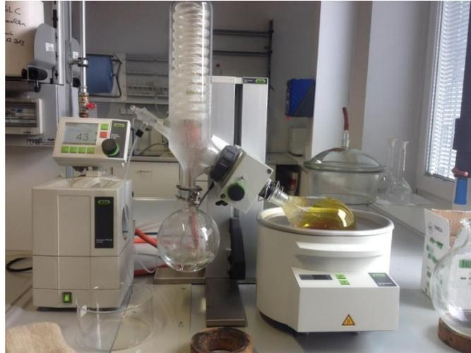
Abbildung 4-8: Wasserverdampfung mittels Rotationsverdampfers der Firma BUCHI
