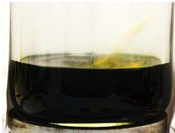
Abbildung 5-10: H<sub>2</sub>O<sub>2</sub>-Zugabe während der Laugung
