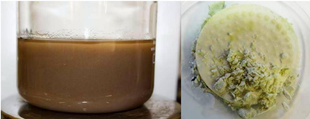
Abbildung 5-11: Lösung nach der Zugabe von Oxalsäure und SE-Rückstand unmittelbar nach der Filtration
