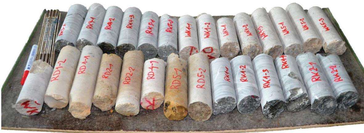
**Abbildung 49: Hergestellte Bohrkern**
