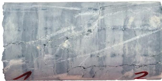
**Abbildung 5: Raibler Kalk - Bohrkern  $\varnothing$  50 mm**
