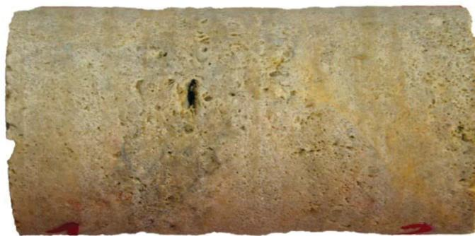
Abbildung 7: Raibler Dolomit – Bohrkern ø 50 mm
