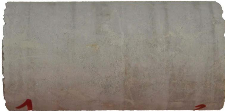
**Abbildung 4: Wettersteinkalk – Bohrkern ø 50 mm**
