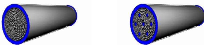
Abbildung 17: Optionen zur Wabenkatalysatorkühlung; rechts mit Kühlung (blau) der Außenwand und links mit zusätzlichen Kühlkanälen (blau) [67].
