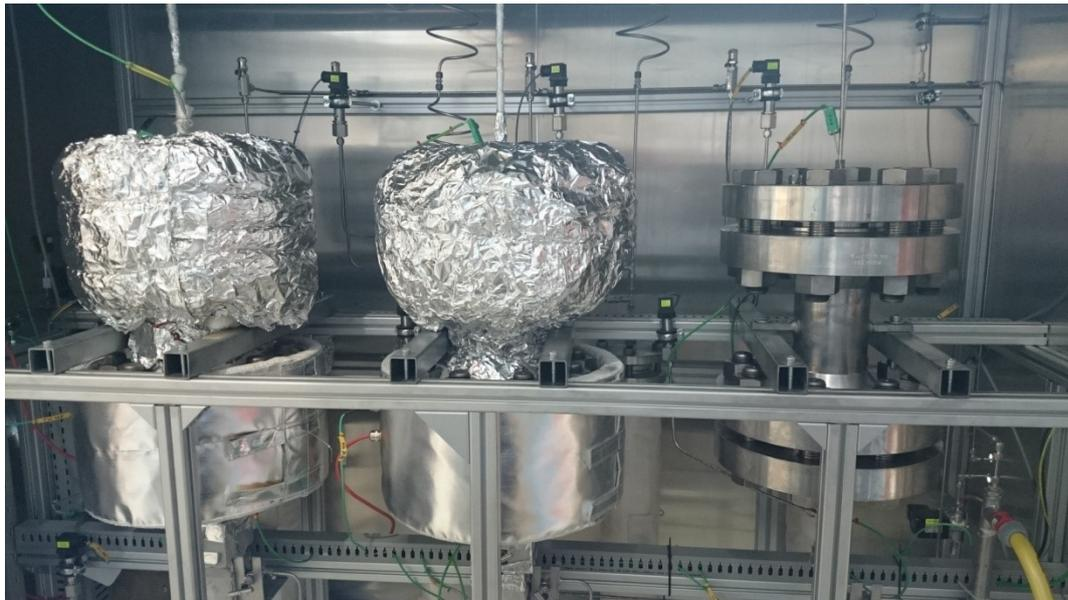
Abbildung 23: Methanisierungsanlage; Reaktor 1 und 2 mit Heizmanschette und Isolierung auf der oberen Flansch, sowie Reaktor 3 entkleidet (rechts)
