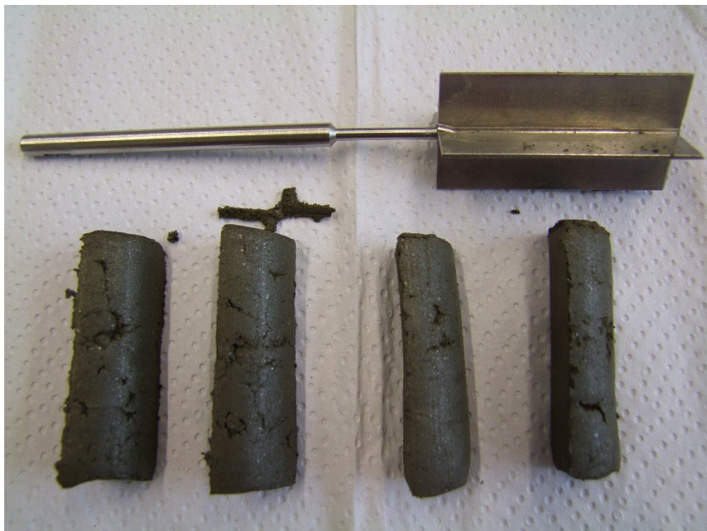
Abb. 8-12: Probe Nr. 19 nach Flügelsondenversuch
