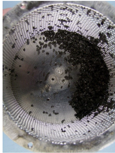
Abb. 5-8: Opalinuston 1; Siebrückstand nach 4 Durchläufen auf 1 mm Sieb Abb. 5-9: Opalinuston 1; Siebrückstand nach 4 Durchläufen in der Trommel
