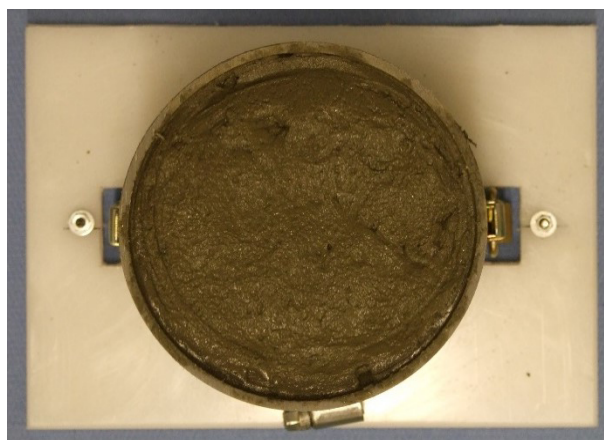
Abb. 7-17: Einbringung Probe Nr. 15; endverdichtet
