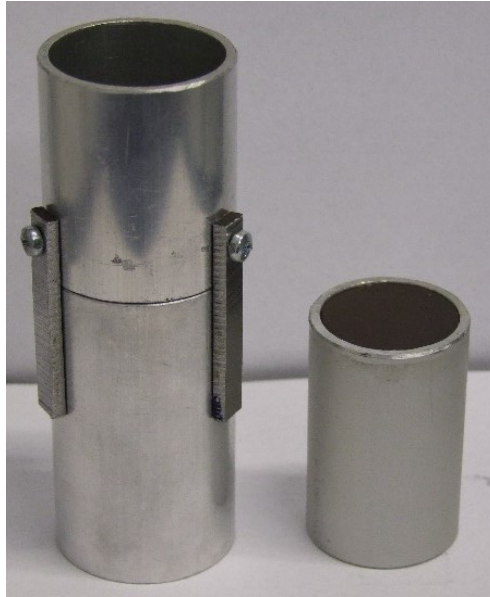
Abb. 8-3: Probengefäß mit Aufsatzzylinder zur Probenvorbereitung
