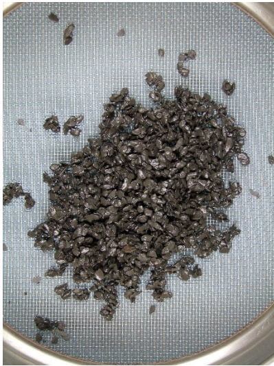
Abb. 5-8: Opalinuston 1; Siebrückstand nach 4 Durchläufen auf 1 mm Sieb Abb. 5-9: Opalinuston 1; Siebrückstand nach 4 Durchläufen in der Trommel
