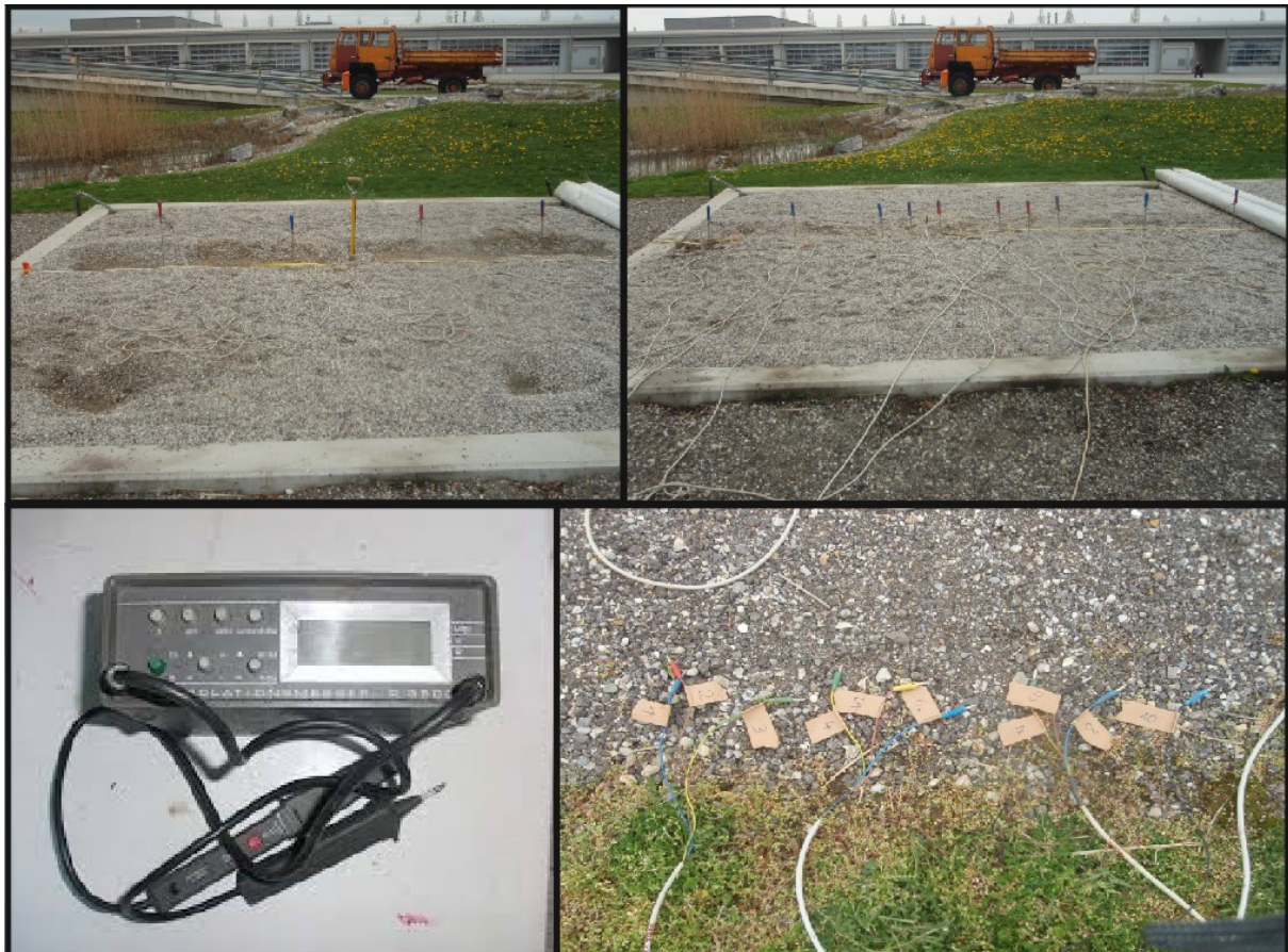
Abbildung 44: Geoelektrik: links oben: Wenner-Alpha: a=1,0\text{m} und SP; rechts oben: Wenner-Alpha: a=0,5\text{m} , a=1,0\text{m} und a=1,5\text{m} ; links unten: Erdungsmessgerät; rechts unten: Elektroden mit Beschriftung für Wenner-Alpha rechts oben.
