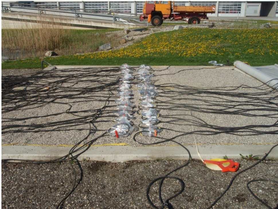
Abbildung 57: Multielektroden Geoelektrik: links Profil 1 und rechts Profil 2; Elektrodenabstand 25 cm.
