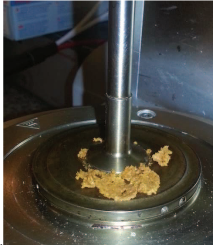
Abbildung 31: WPC-Probe wurde nach stationärem Versuch aus dem Messspalt herausgeschleudert
