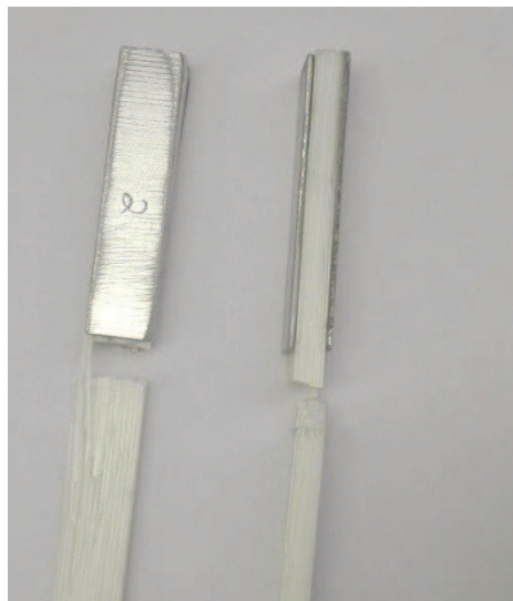
Abbildung 45: UD-gedruckter Zugprüfkörper mit Aufleimer
