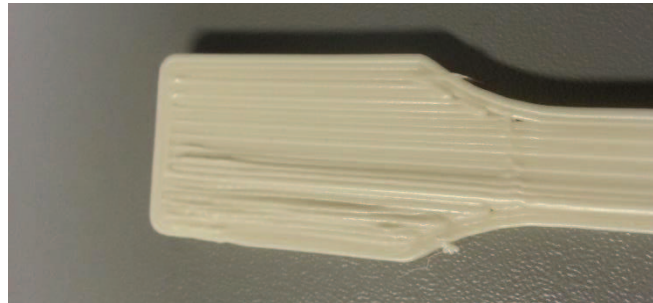
Abbildung 44: Unebenheit der Oberfläche aufgrund von Materialüberschuss
