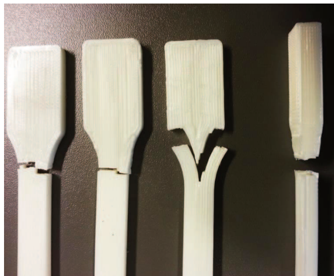
Abbildung 43: Bruchbild der unterschiedlichen Geometrien
