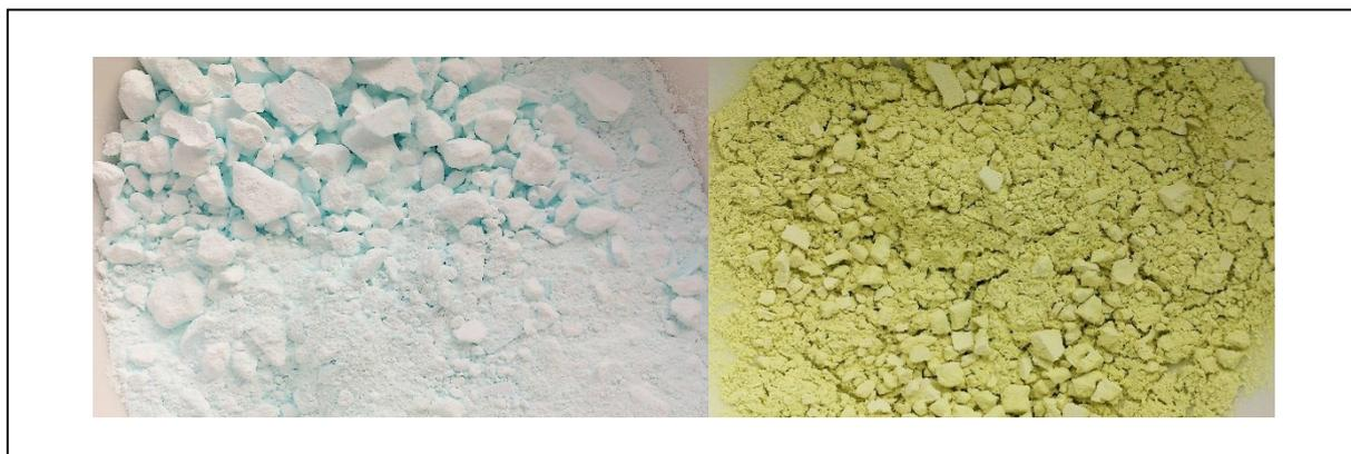
Abbildung 18: Rückstand vor und nach dem Glühen zur möglichst vollständigen Umwandlung in Oxide
