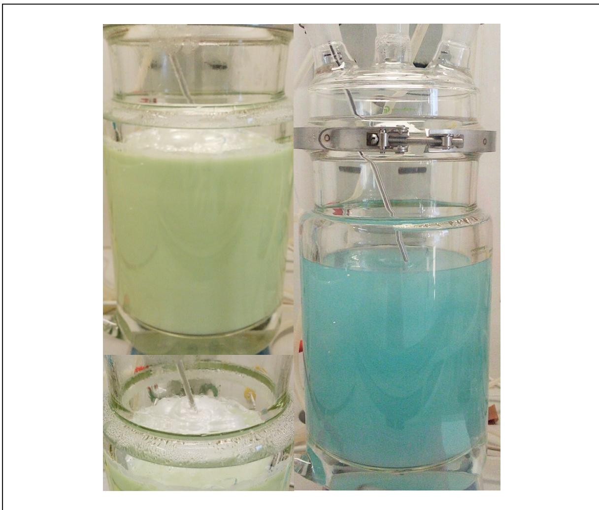
Abbildung 9: Synthetische Lösung zum Beginn und nach der Auflösung der Feststoffe
