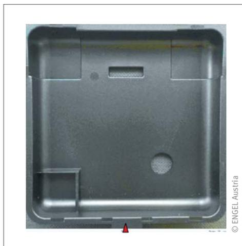
**Рисунок 1. Деталь-образец с ребрами жесткости, изменением толщины стенок и отверстиями (красный треугольник — место литника)**
