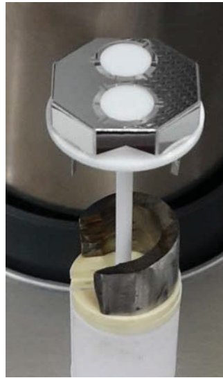
Abbildung 4-7: DSC-Sensor mit Auflagescheiben und Zr-Getter.
