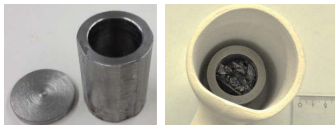
Abbildung 5-7: Reineisenzylinder mit Deckel (links), Legierungselemente im Tiegel (rechts).
