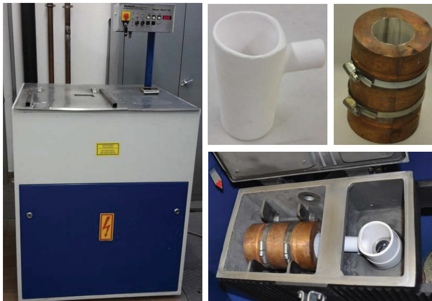
Abbildung 5-6: HFU (links), Tiegel (oben mitte), beschichtete Kupferkokille (oben rechts), Schleuderkammer (unten rechts).
