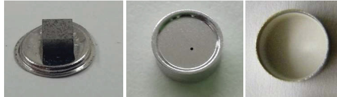
Abbildung 4-10: Ankleben der Probe am Tiegel (links), Probentiegel mit Deckel (mitte), Inlayer (rechts).
