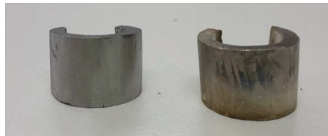
Abbildung 7-3: Zr-Getter vor der Messung (links), nach der Messung (rechts).
