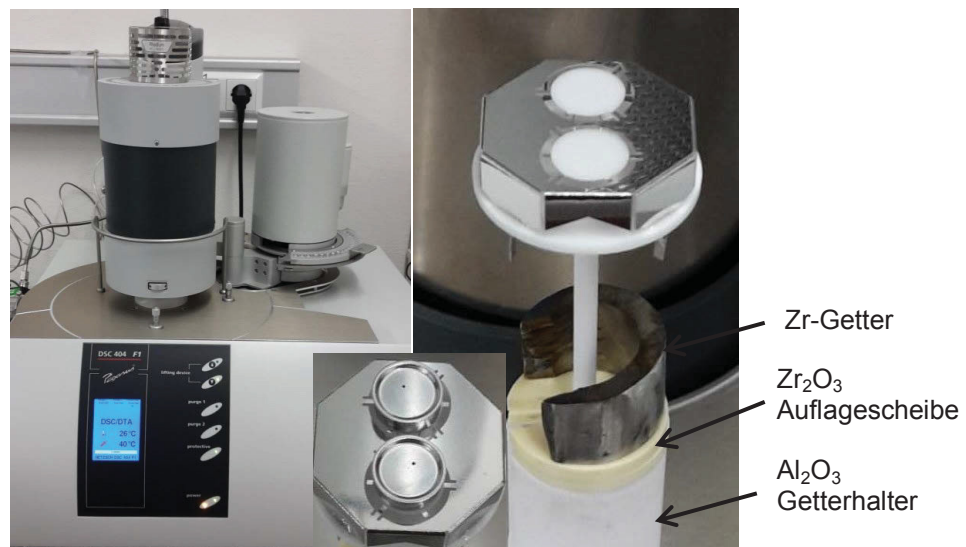
Abbildung 7-2: DSC-Messgerät (rechts), Probenträger mit Zr-Getter und \text{Al}_2\text{O}_3 Unterlagscheiben (links), aufgesetzte Tiegel (mittig).
