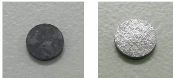
Abbildung 4-8: Messung von Reineisen ohne Getter (links), mit Getter (rechts).
