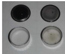
Abbildung 5-14: Abdampfverhalten von Mangan, sauberer Tiegel (rechts), verunreinigter Tiegel (links).
