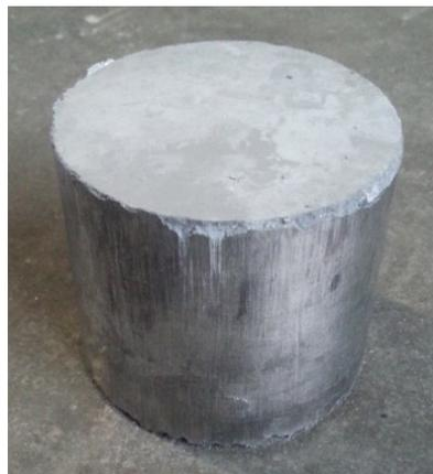
Abbildung 32: Gepresstes und einsatzbereites Brikett aus aluminiumhaltigem Reststoff
