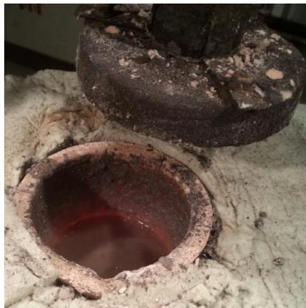
Abbildung 36: Schmelzflüssiges Gemisch aus Aluminium-Vorlage, Schmelzsatz und zwei Briketts
