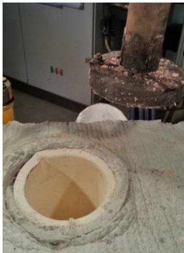
Abbildung 34: Tiegel mit Feuerfest-Ummantelung und Deckel des ITG (oben rechts)
