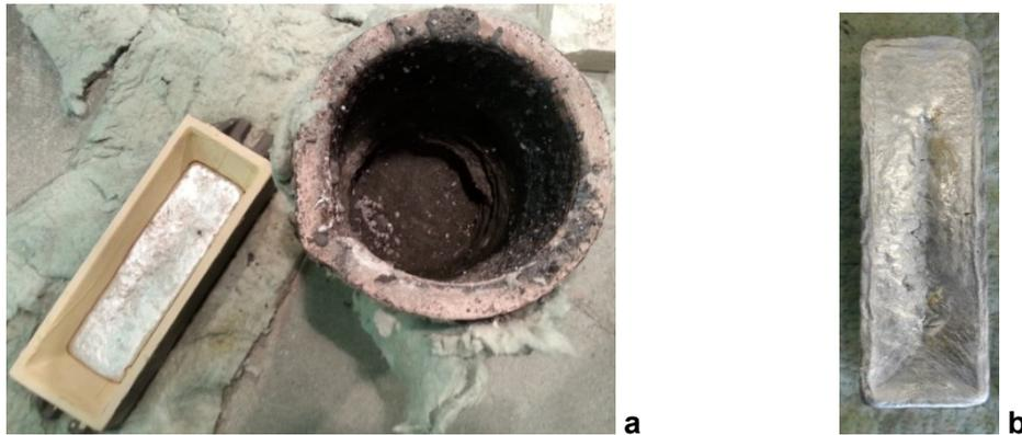
Abbildung 38: Abgegossenes Aluminium und Tiegel mit Restschlacke (a) und abgekühlter Massel (b)
