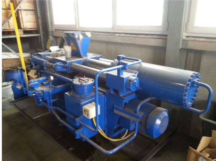
Abbildung 31: Technikums-Pressen ArnoBrik der der Fa. ATM Recyclingsystems ([45])
