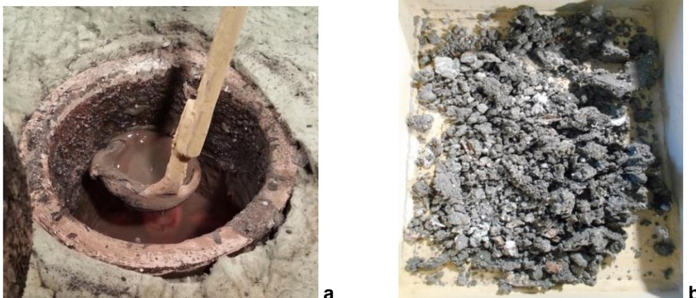
Abbildung 37: Abguss-Schritt 1: Entfernung der Schlacke (a) und entfernte Schlacke (b)
