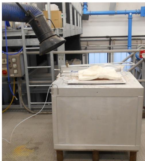
Abbildung 39: Widerstandsofen mit Absaugung (links oben) und Argon-Spülung (dünner Schlauch links) und Abdeckung aus Feuerfestwolle
