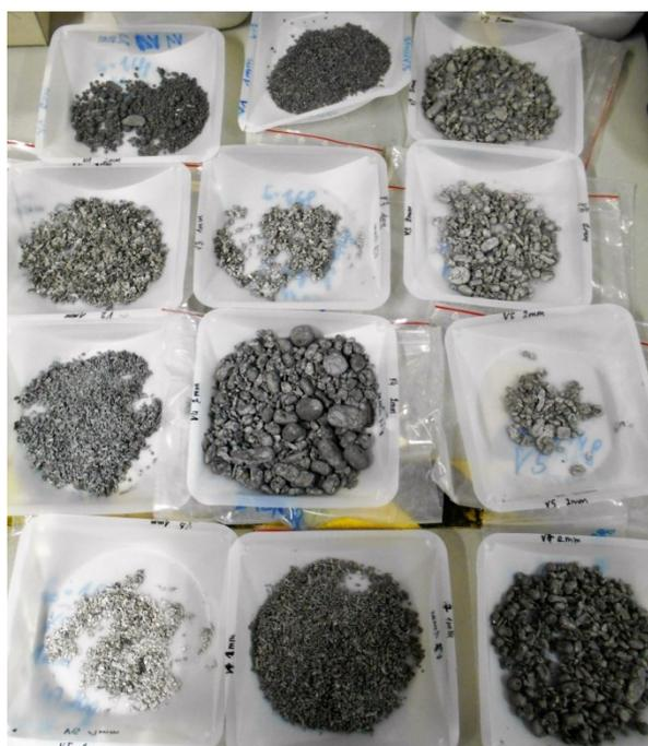
Abbildung 43: Darstellung der 1 mm und 2 mm großen Fraktionen nach dem Waschen
