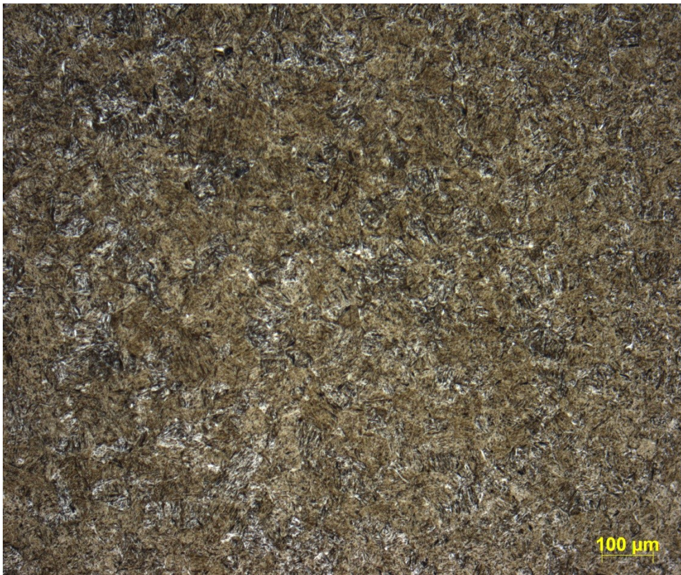
Abb. 109 Gefüge im Oberflächenbereich eines Flansches abgeschreckt von 1000°C für 20s in einem Becken mit 8%iger AQ320-Lösung, Temperatur des Härtemediums 32°C, geätzt mit Nital 3%
