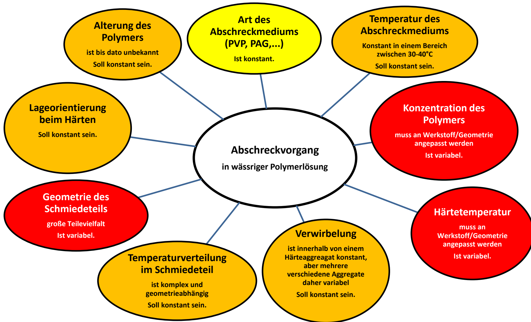
Abb. 2 Überblick über die wichtigsten Einflüsse beim Härten aus der Schmiedewärme in wässriger Polymerlösung (Einfärbe-Modus siehe Text)
