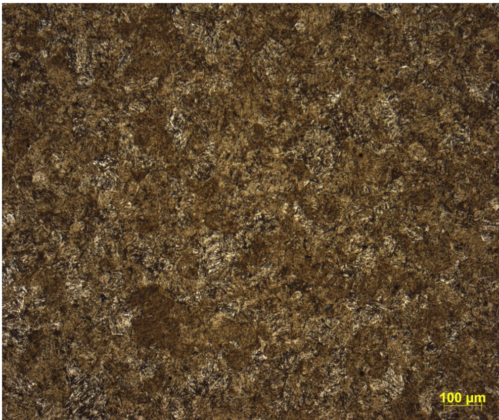
Abb. 99 Gefüge im Oberflächenbereich eines Flansches abgeschreckt von 900°C für 20s in einem Becken mit 8%iger AQ320-Lösung, Temperatur des Härtemediums 32°C, geätzt mit Nital 3%
