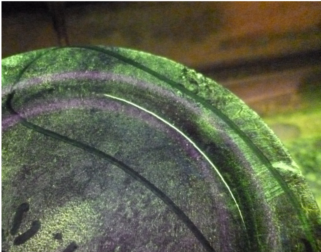
Abb. 119 Härteriss im Bereich des Geometrieübergangs, Magnetpulverprüfung (MT)
