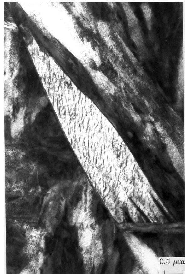
Abb. 36 TEM-Aufnahme eines Bereiches von unterem Bainit in einem 0,46C-2,10Si-2,15Mn Stahl, Karbidausscheidungen innerhalb der Nadeln [41]
