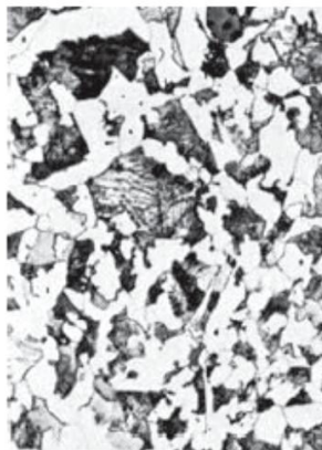
b) Luft, Ferrit + Perlit
