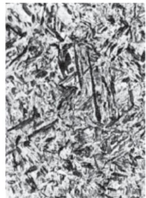
c) Öl, feinstreifiger Perlit + Ferritnetz
