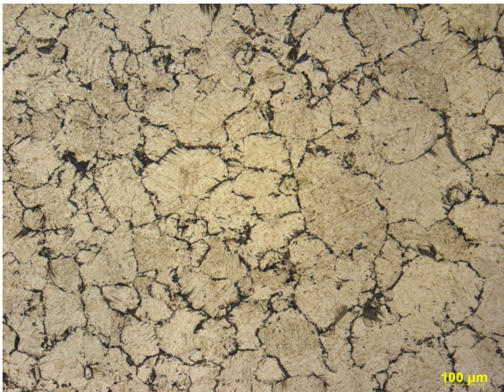
Abb. 86 Flansch gehärtet: Randbereich, geätzt mit Nital 3%
