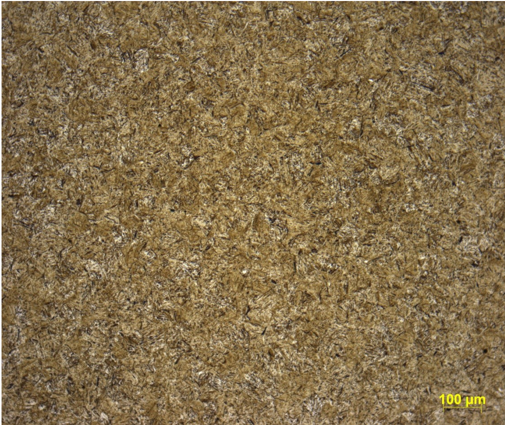
Abb. 112 Gefüge im Oberflächenbereich eines Flansches abgeschreckt von 1000°C für 30s in einem Becken mit 8%iger AQ320-Lösung, Temperatur des Härtemediums 32°C, geätzt mit Nital 3%
