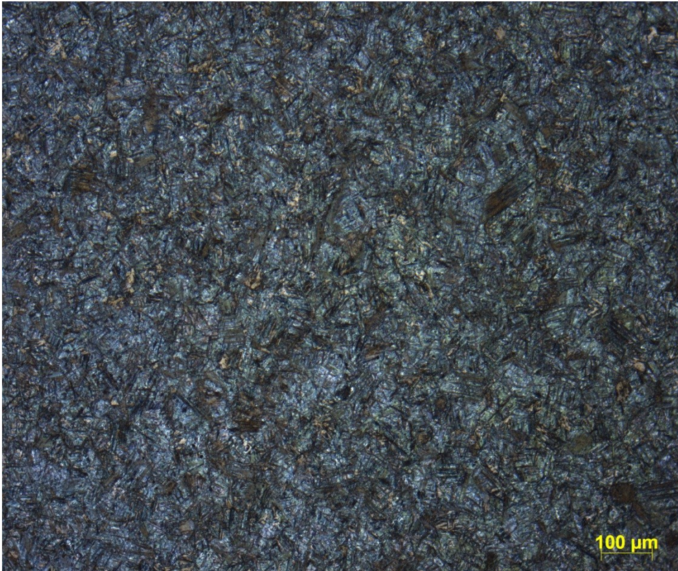
Abb. 96 Gefüge in 3mm Abstand von der Oberfläche eines Flansches abgeschreckt von 900°C für 10s in einem Becken mit 8%iger AQ320-Lösung, Temperatur des Härtemediums 32°C, geätzt mit Nital 3%
