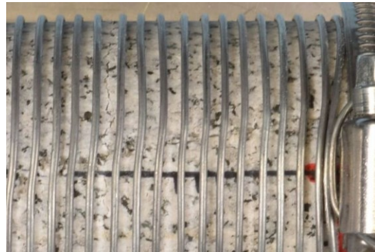
Abbildung 53: Deformationen im Draht über dem Riss
