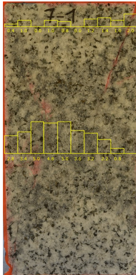
Abbildung 39: Rissauswertung der Probe BBK-351-07
