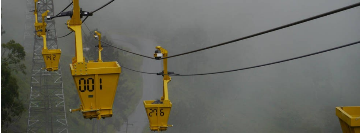
Abbildung 16: Materialeilbahn (Leitner AG)
