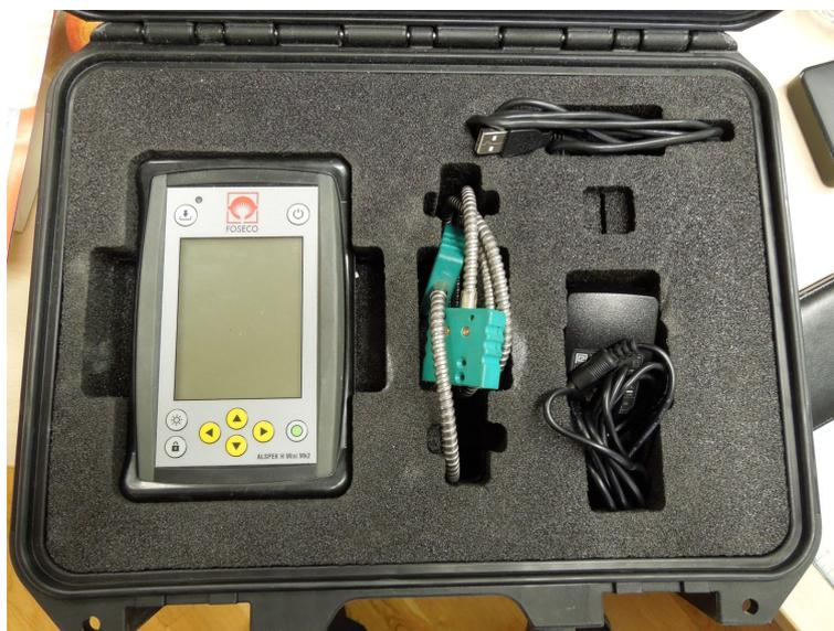
Abbildung 97: Wasserstoffgehaltsmessgerät „Alspek H mini“
