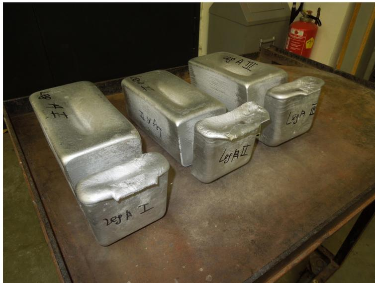
Abbildung 98: Erzeugte Gussbarren von Legierung A aus dem vergrößerten Labormaßstab
