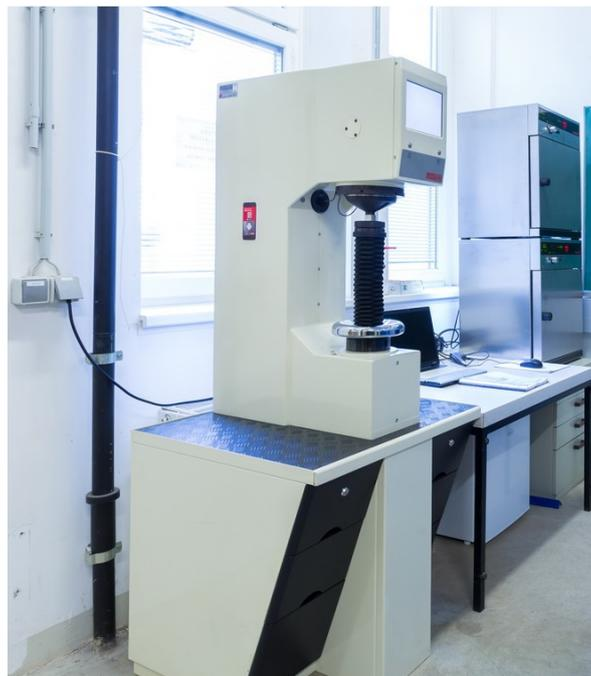
Abbildung 33: Universalhärteprüfgerät EMCO-M4C-025-G3 [109]
