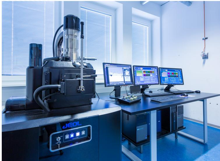
Abbildung 39: Rasterelektronenmikroskop Jeol JSM-IT300-LV mit EDX-Analyse [123]
