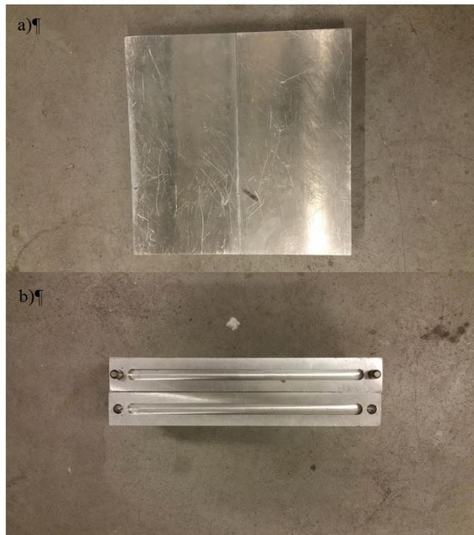
Abbildung 48: a) Draufsicht bei der Platte mit Nuten, in welche die Proben eingelegt werden, b) eingefräste Nuten in der Versuchsplatte zur Einlage der Proben [144]
