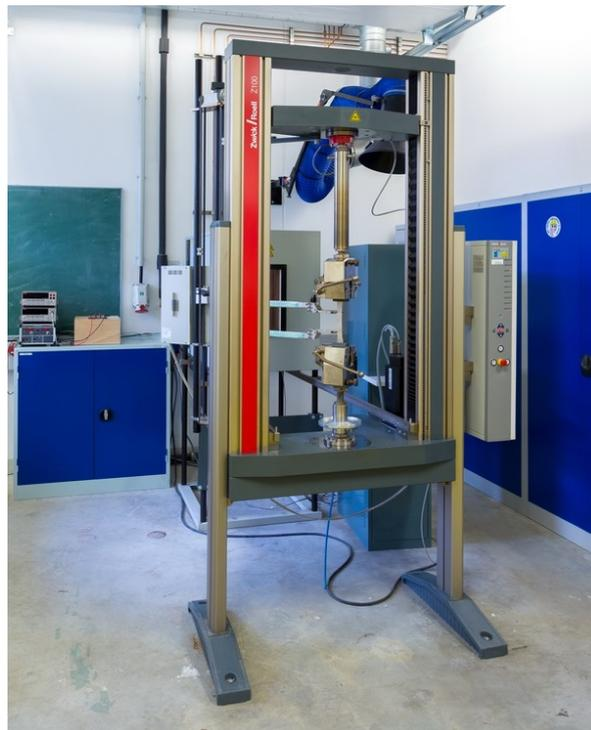
Abbildung 35: Zugprüfmaschine Zwick/Roell Z100 [112]
