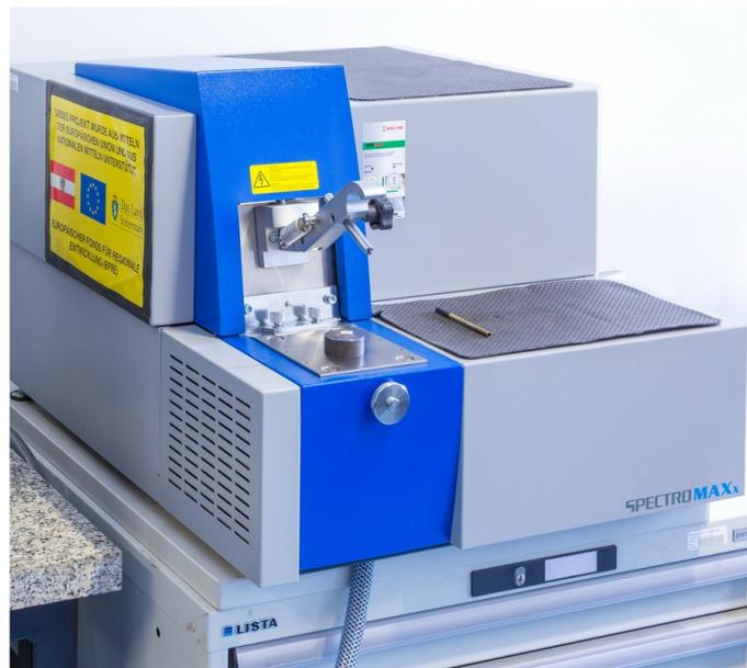
Abbildung 38: Funkenspektrometer der Firma SPECTROMAXx [121]
