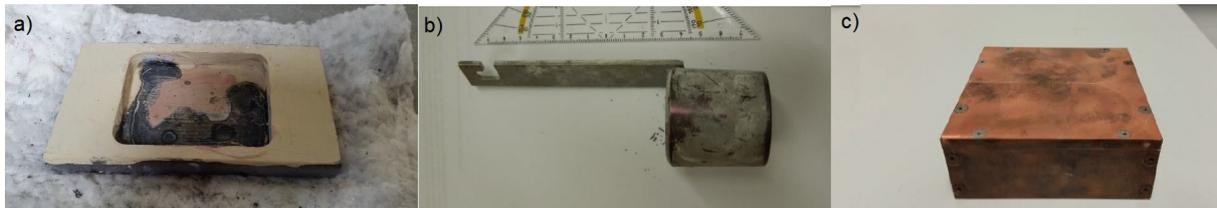
Abbildung 84: Darstellung der Abguss-Formen a) Stahlgießform, b) „Opticast“-Form und c) Kupferblock [150]
