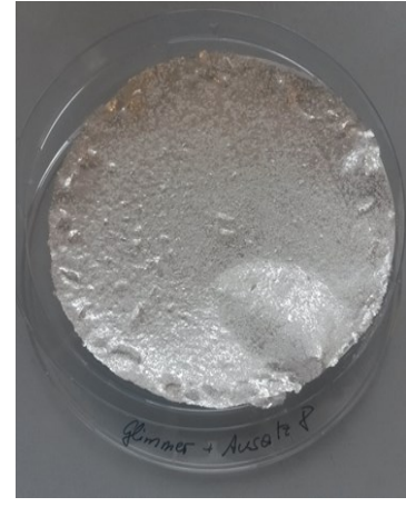
Abbildung 91 Glimmer + Bornitrid, modifiziert mit Silan nach Ansatz 6
