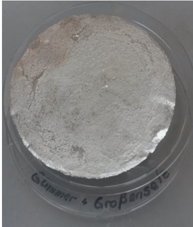
Abbildung 89 Glimmer + Bornitrid, modifiziert mit Silan (Großansatz)
