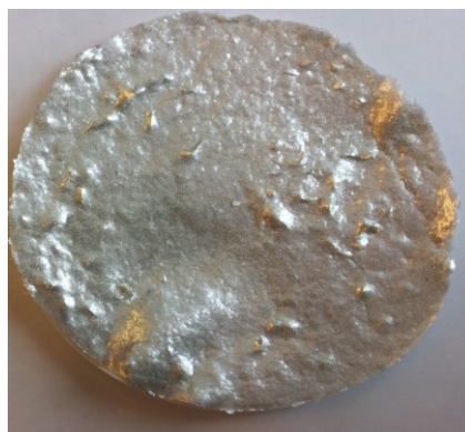
Abbildung 94 Papier mit 5 Gew.-% PVOH-modifiziertem Bornitrid
