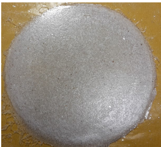
Abbildung 111 mit Harz verpresste Glimmerpapiere (3 Lagen)
