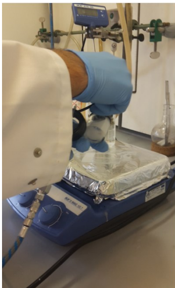
Abbildung 75 Auftragung der Polyelektrolyte mittels Airbrush
