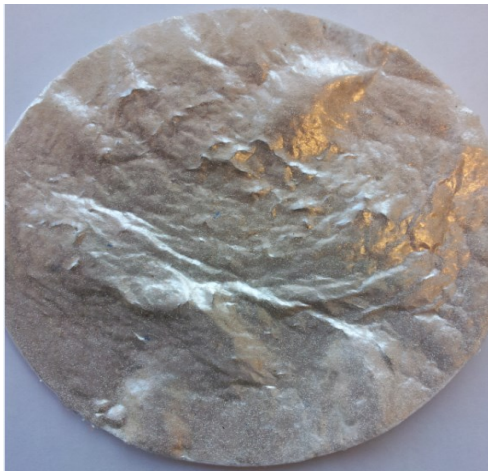
Abbildung 168 Papierherstellung mit 5 Gew.-% PVOH
