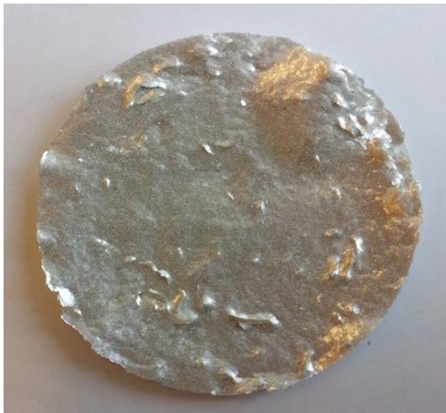
Abbildung 172 Papier mit 0,5 Gew.-% PVOH-Lösung modifiziertem Bornitrid
