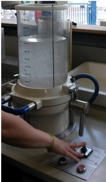
Abbildung 102 Blattbildende Säule der Rapid Köthen Versuchsanlage
