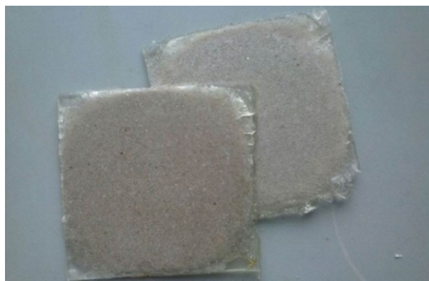
Abbildung 134 Fertiges Komposit (Glimmerlagen) nach Tränkung
