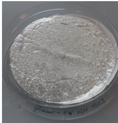
Abbildung 88 Glimmer mit unmodifiziertem Bornitrid VSN 1363
