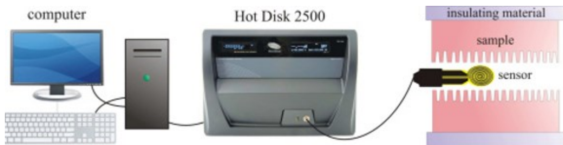
Abbildung 18 Schematische Darstellung des experimentellen Setups einer Hot-Disk 2500 (thermisch-konstanter Analysator) basierend auf der transient plane source – Methode (TPS) [115]
