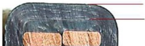
Abbildung 2 Hauptisolation: Verbund aus Glimmer und Reaktionsharz
