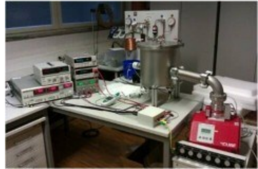
Abbildung 27 Aufbau für die thermische Charakterisierung dünner Schichten mit der 3-Omega-Methode
