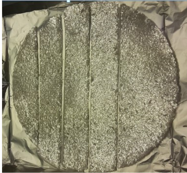
Abbildung 110 Glimmerstreifen zur Messung der Reisskraft von Glimmerpapieren
