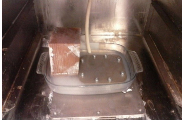
Abbildung 132 Vorrichtung für Tränkung im Vakuumtrockenschrank
