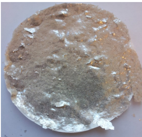
Abbildung 170 Papierherstellung mit 0,1 Gew.-% PVOH
