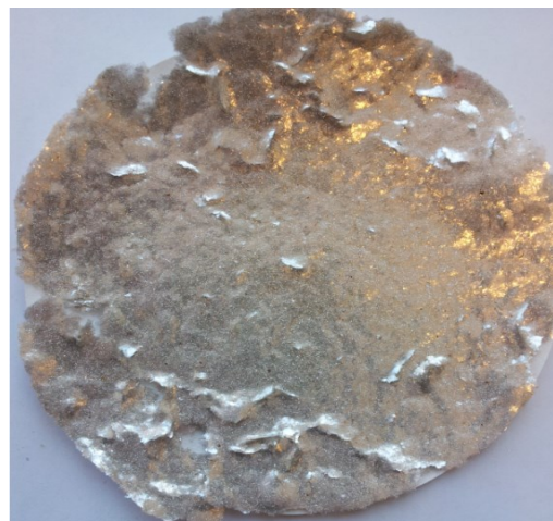
Abbildung 171 Papierherstellung mit 0,01 Gew.-% PVOH
