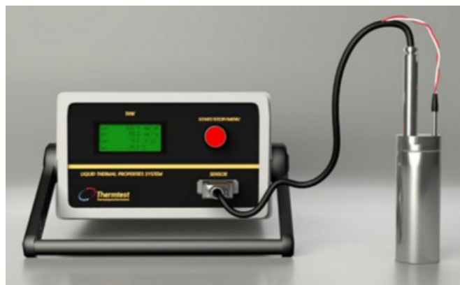
Abbildung 23 Messgerät von Thermtest "THL-L1" für die Messung der Wärmeleitfähigkeit mit der "hot-wire-Methode" [128]
