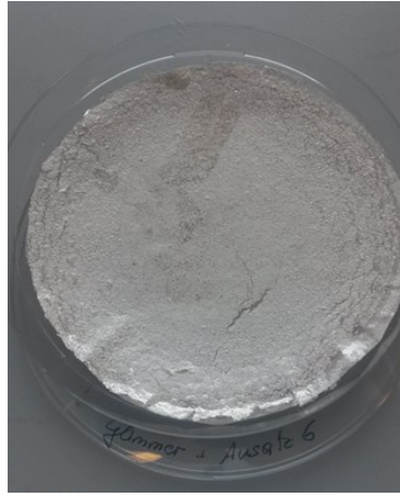
Abbildung 90 Glimmer + Bornitrid, modifiziert mit Silan nach Ansatz 6
