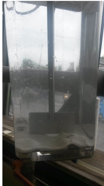
Abbildung 103 Dispergier-säule der Rapid Köthen Versuchsanlage
