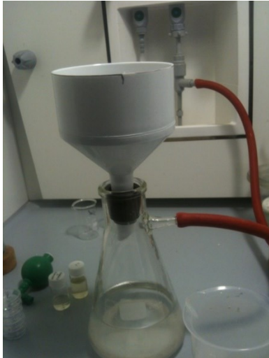
Abbildung 85 Versuchsaufbau Papierherstellung mit Büchnertrichter
