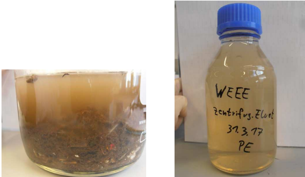
Abbildung 24: Links: das unbehandelte Eluat der Elektronikabfall-Probe. Rechts: das Eluat nach dem Zentrifugieren
