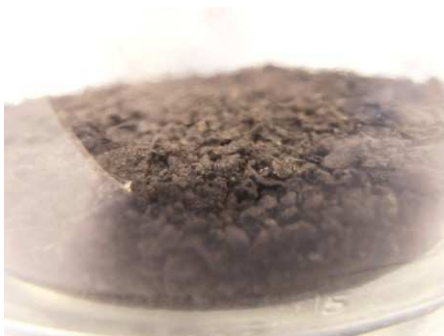
Abbildung 25: Batterieaktivmaterial, Korngröße < 2 mm
