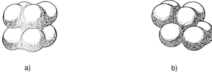
Abb. 12: Anordnung innerhalb einer Kugelpackung: a) kubische Anordnung, b) rhomboedrische Anordnung [12]
