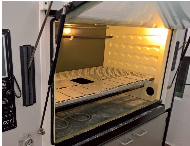
Abbildung 5-4: Geöffnete Klimakammer mit eingelegten FFC-Proben nach Versuchsende
