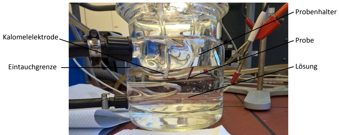
Abbildung 5-9: Messzelle für die Korrosionspotentialmessungen
