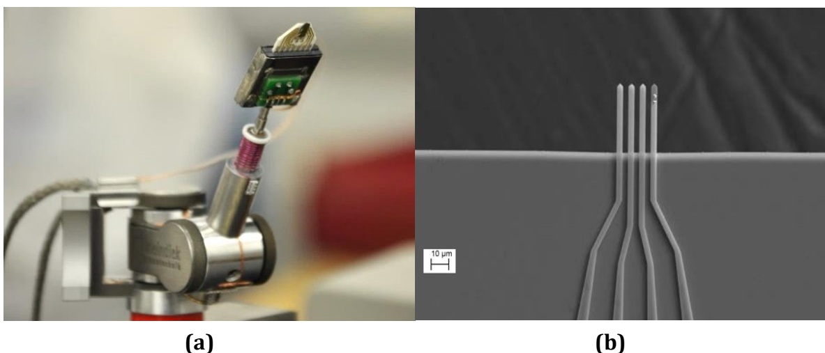
Abbildung 19: (a) Detailaufnahme des Mikromanipulators der Firma Kleindiek Nanotechnik GmbH samt Messkopf der Firma Capres A/S. (b) REM-Aufnahme der 4 vergoldeten Messspitzen.
