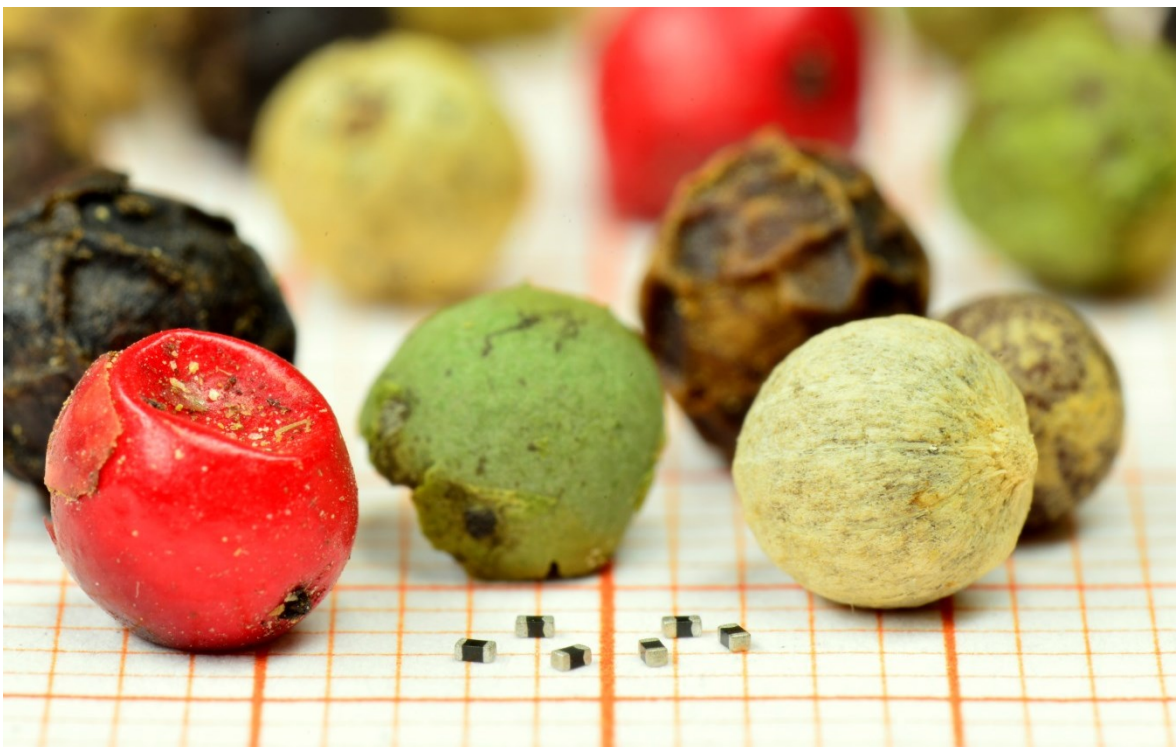
Abbildung 9: Multilayer-Varistoren des Typs MLV 0201 der Firma EPCOS OHG im Größenvergleich mit bunten Pfefferkörnern auf Millimeterpapier.
