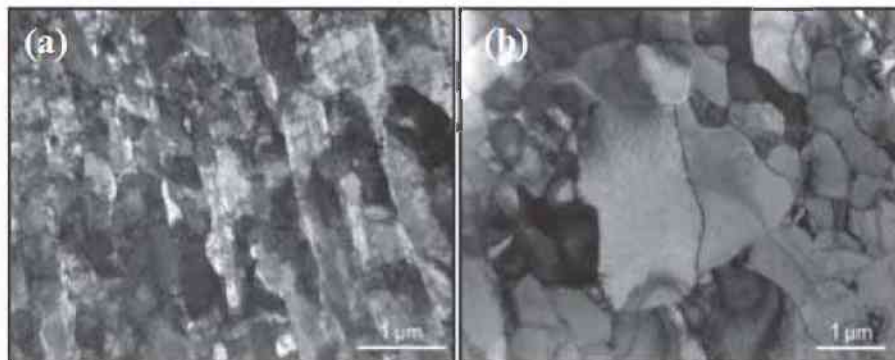
Abb. 2.14.: (a) Mikrostruktur von Kupfer nach ECAP; (b) Mikrostruktur nach dehnungsgesteuerter zyklischer Belastung [17].
