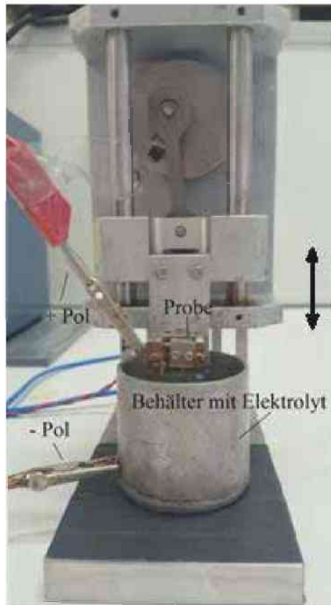
Abb. 3.2.: Apparatur zum Eintauchen der Probe und Elektroden zur Spannungsanlegung..
