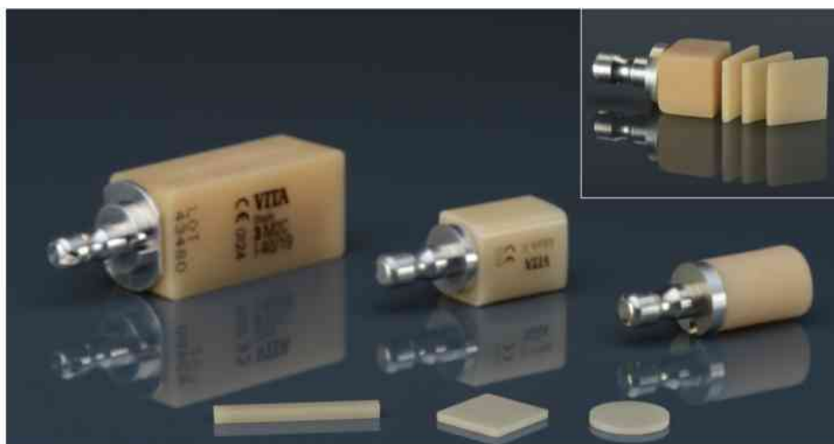
Abbildung 1.1.: Beispiele für CAD/CAM-Blöcke, wie sie zur Endbearbeitung verkauft werden. Darunter zu sehen sind die Proben die daraus geschnitten werden können. Nur sehr lange Blöcke (linker Block: 19 \times 19 \times 40 \text{ mm}^3 ) eignen sich für die Herstellung von standardisierten 4-Punkt-Biegeproben. Die Abbildung wurde mit Erlaubnis aus [2] reproduziert.
