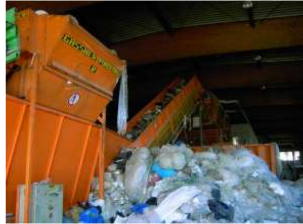
Abbildung 56: Sackaufreißer mit Förderband zum Trommelsieb 70
