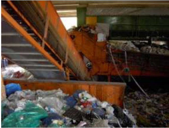
Abbildung 56: Sackaufreißer mit Förderband zum Trommelsieb 70
