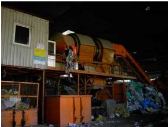
Abbildung 57: Trommelsieb 70 und Sortierstraße; Trommelsieb 70 mit darunter liegendem Magnetabscheider II
