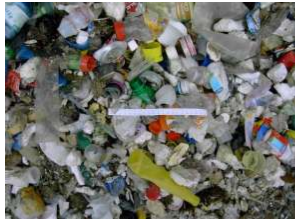
Abbildung 62: Lager NGA: Überlauf gmA; gmA Siebdurchgang 0 – 80 mm
