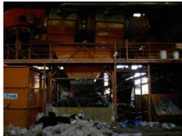
Abbildung 57: Trommelsieb 70 und Sortierstraße; Trommelsieb 70 mit darunter liegendem Magnetabscheider II
