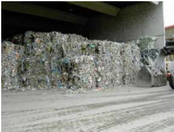
Abbildung 62: Lager NGA: Überlauf gmA; gmA Siebdurchgang 0 – 80 mm
