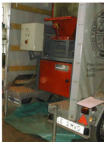
Abbildung 6.9: Doppelwellenzerkleinerer des Institutes für nachhaltige Abfallwirtschaft und Entsorgungstechnik (IAE)
