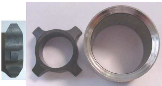
Bild 130: SSN-Anschlagstern und M390-Sperring nach dem Rückstromsperren-Verschleißversuch.
