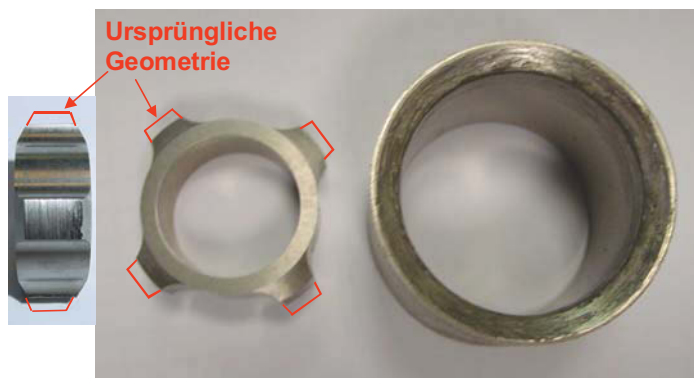
Bild 128: M390-Anschlagstern und M390 Sperring nach dem Rückstromsperrren-Verschleißversuch.
