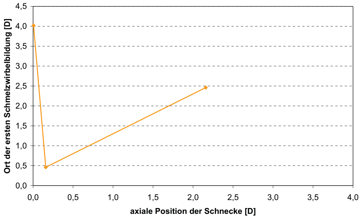
Bild 115: Ort der ersten Schmelzwirbelbildung für Versuch Nummer 10 ( 100 \text{ min}^{-1} Drehzahl, 4D Dosierweg, 120 bar Staudruck).
