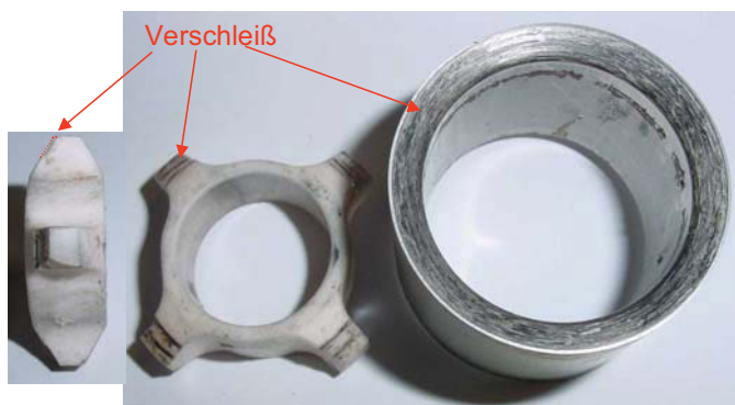
Bild 132: Al_2O_3 -Anschlagstern und M390-Sperring nach dem Rückstromsperrren-Verschleißversuch.
