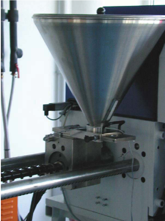
Bild 58: Versuchsanordnung zur Bestimmung der Feststoffförderkapazität verschiedener Schnecken.
