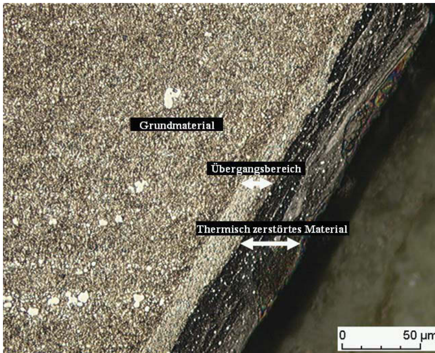
Bild 125: Metallurgischer Schliff im Bereich der Verschleißstelle an den Flügeln der Schneckenspitze.
