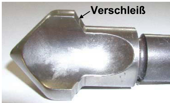
Bild 141: Verschleiß an der Schneckenspitze mit 2° angeschrägten Flügeln nach dem Verschleißversuch mit einer Drehzahl von 300 \text{ min}^{-1} (Werkstoff: M390 durchgehärtet).
