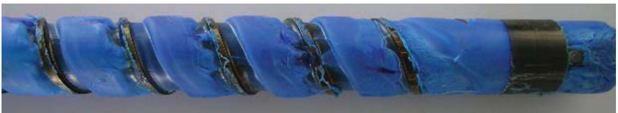
Bild 83: Nach dem Einspritzen aus dem Zylinder gezogene Schnecke.
