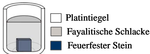
Abbildung 6: Schematische Darstellung der Versuchsanordnung der Methode II.
