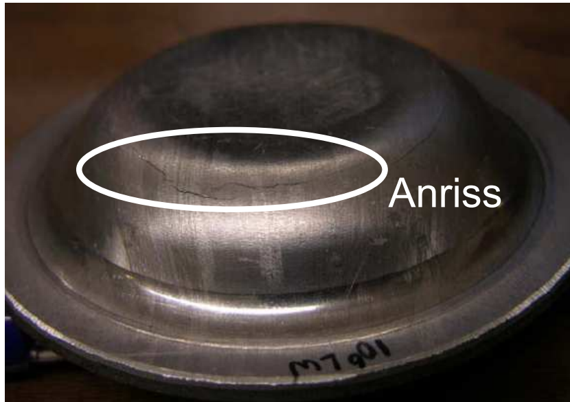
Abbildung 12.12: Bruchübersicht der geschädigten Rundsicke, außen
