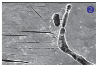
Abbildung 5-2: Illustration der Vorgänge in einem Korrosionsriss
