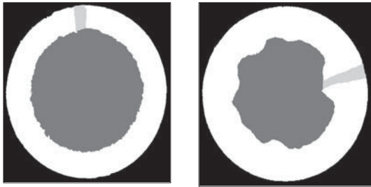
Abb. 3-3: Unterschiedliche Verformung an der Röhreninnenseite
