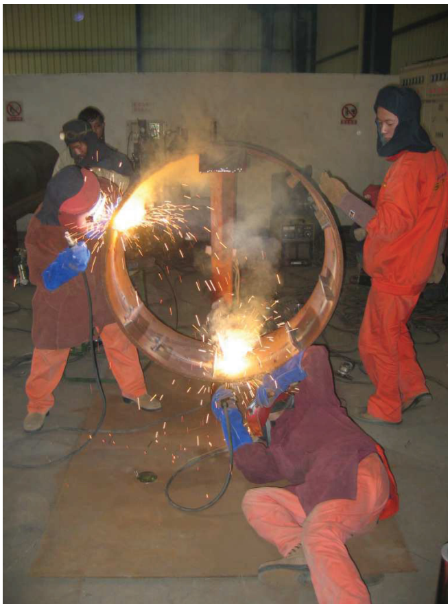
Abb. 6-6: Wurzelschweißung am Proberohr X70 1016x14,6mm
