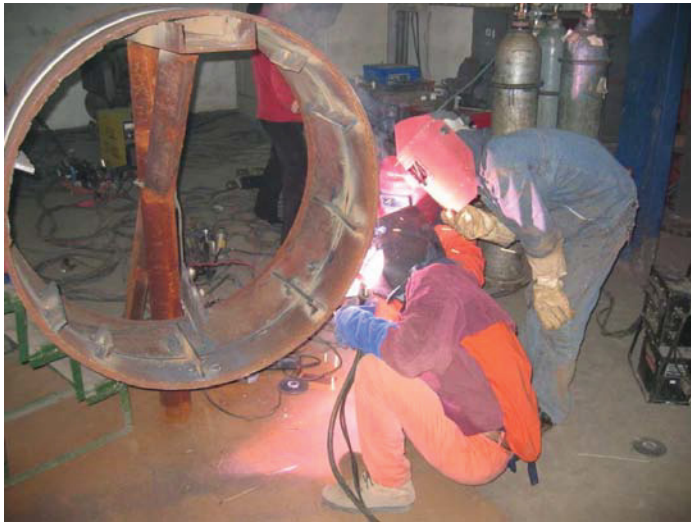
Abb. 6-7: Fülllagenschweißung mit der Nullserie SNr. 2961 (Ma.00168) des selbstschützenden Fülldrahtes
