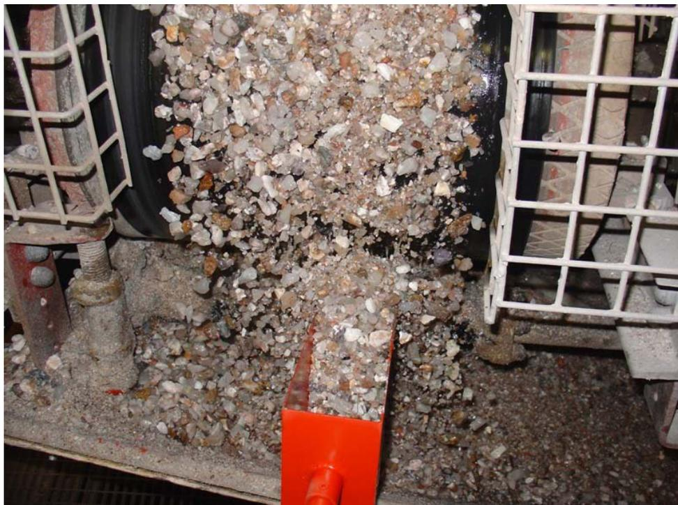
Abbildung 26: Probenahmestelle Konzentrat der Bergeabscheidung
