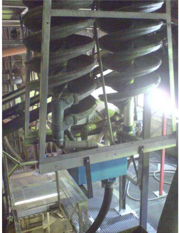
Abbildung 64: Wendelscheideranlage, Austragsseite
