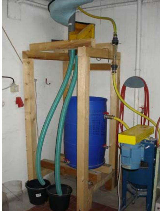
Abbildung 52: Abbildung des Produktaustrages und der Prozesswasserrückgewinnung
