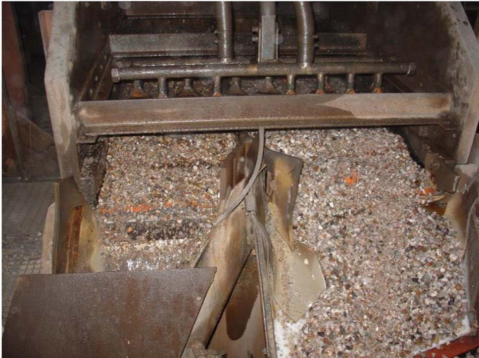
Abbildung 25: Abwurf des Entrübungssiebes der Bergevorabscheidung
