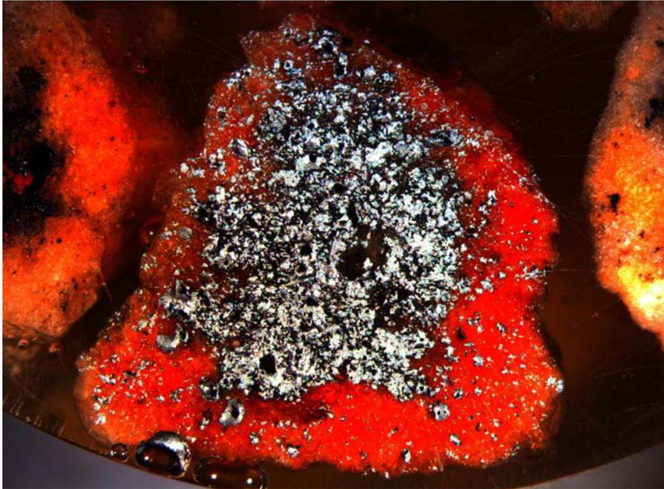
Abbildung 9: Einfärbung der Poren mit Lackstift, erhöhte Farbintensität
