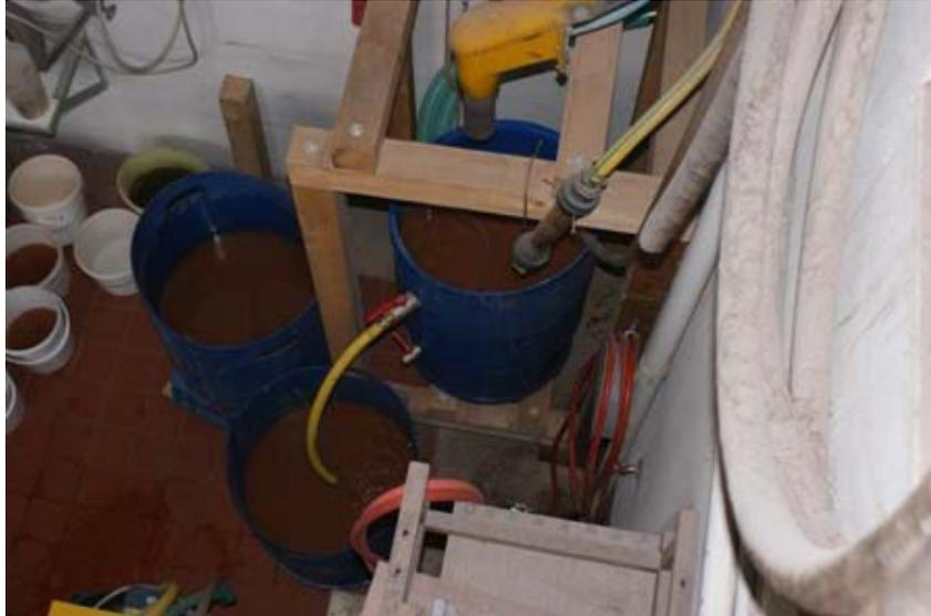
Abbildung 61: Eindickeranlage zur Feingutrückgewinnung
