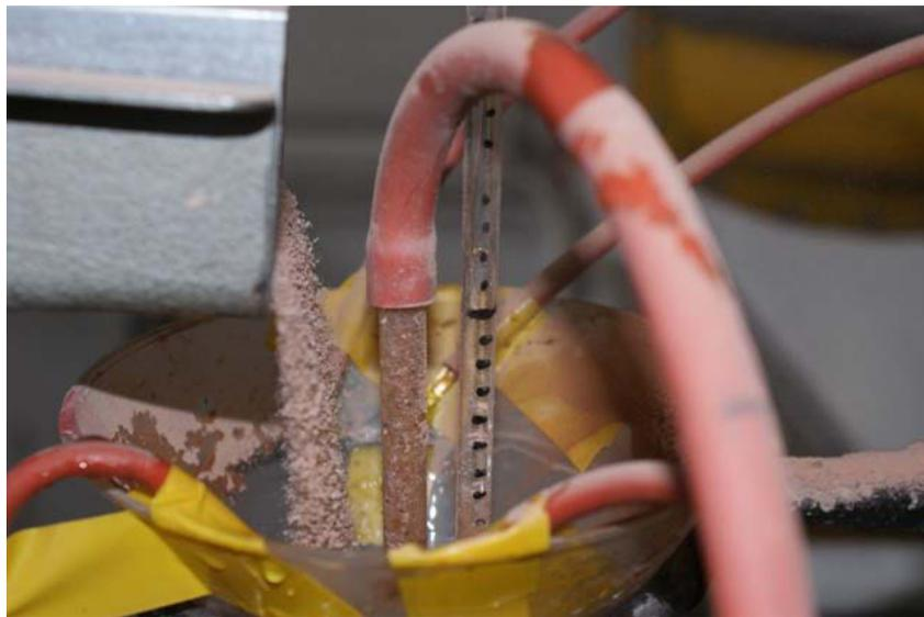
Abbildung 60: Aufgabetrichter mit Dichtemesssonde
