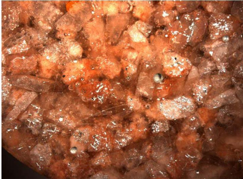
Abbildung 10: Anschliff der Korngrößenklasse 2/1mm, 2,74/3,32 g/cm<sup>3</sup>
