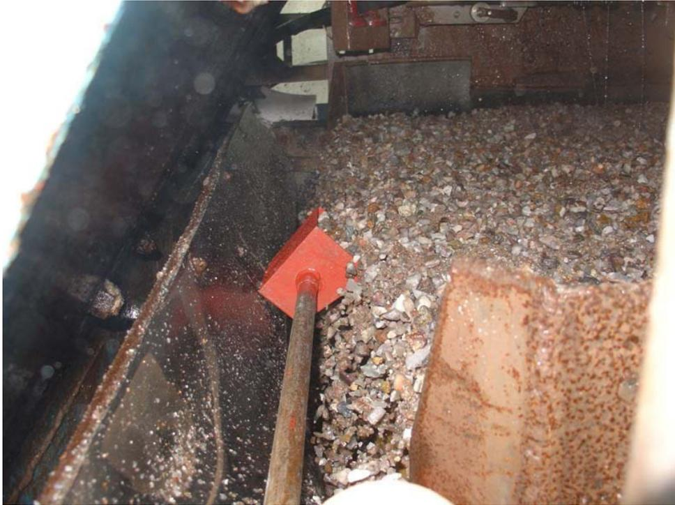
Abbildung 27: Probenahme der Aufgabe beim Abwurf des Waschsiebes
