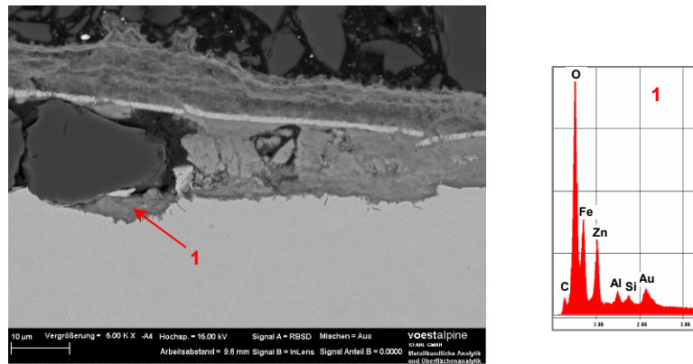
Abbildung 196: REM-Aufnahme und EDX-Spektrum von ZnAl 0.2-beschichtetem Stahlband im Querschliff nach 80 Zyklen im KFW-Test.
