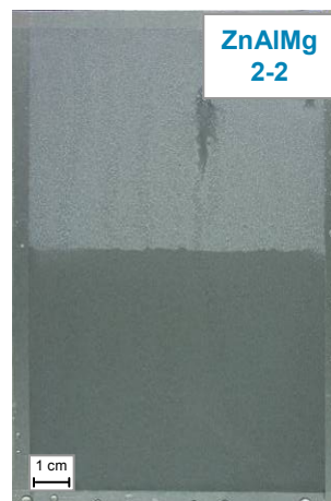
Abbildung 168: ZnAlMg 2-2-beschichtetes Stahlband nach 24 h im Salzsprühtest mit NaCl/NH 4 Cl; oben : trocken, unten : in VE-Wasser getaucht.
