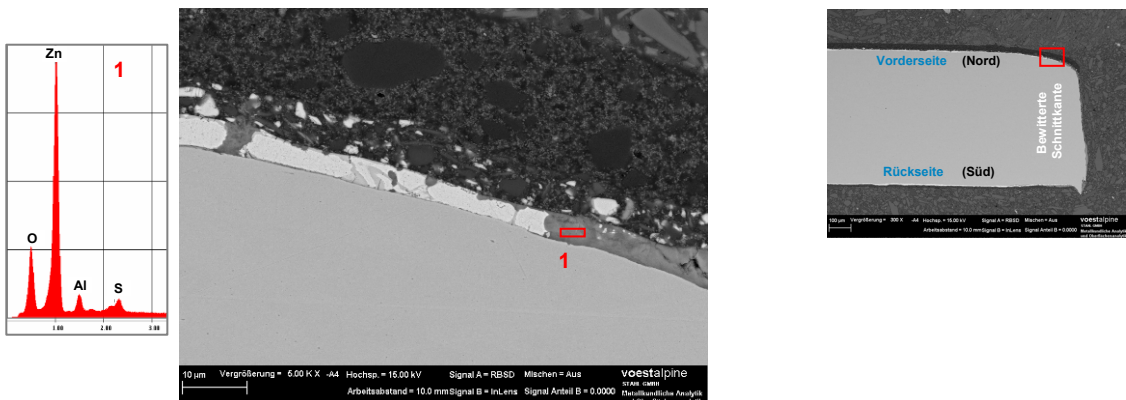
Abbildung 202: REM-Aufnahme und EDX-Spektrum der ZnAlMg 2-2-beschichteten Freibewitterungsprobe, Vorderseite, 60 µm von der Schnittkante entfernt.
