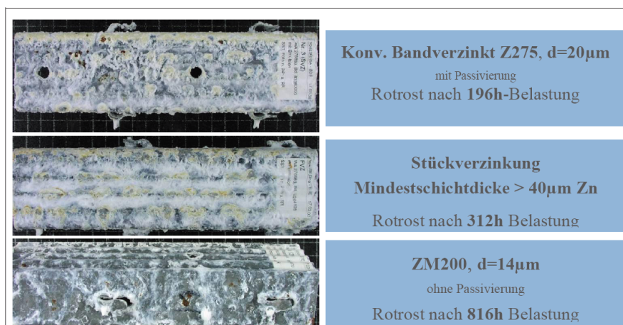
Abbildung 60: Korrosionsbeständigkeit von Realbauteilen (Spalierpfählen) im Salzsprühstest [37].
