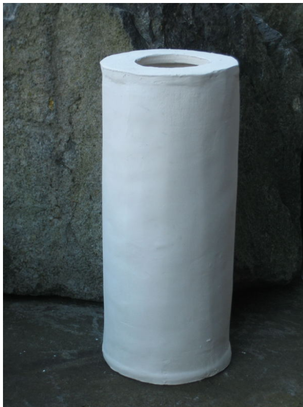
Abbildung 17: Porzellandose mit Außendurchmesser 85 mm und Länge 220 mm
