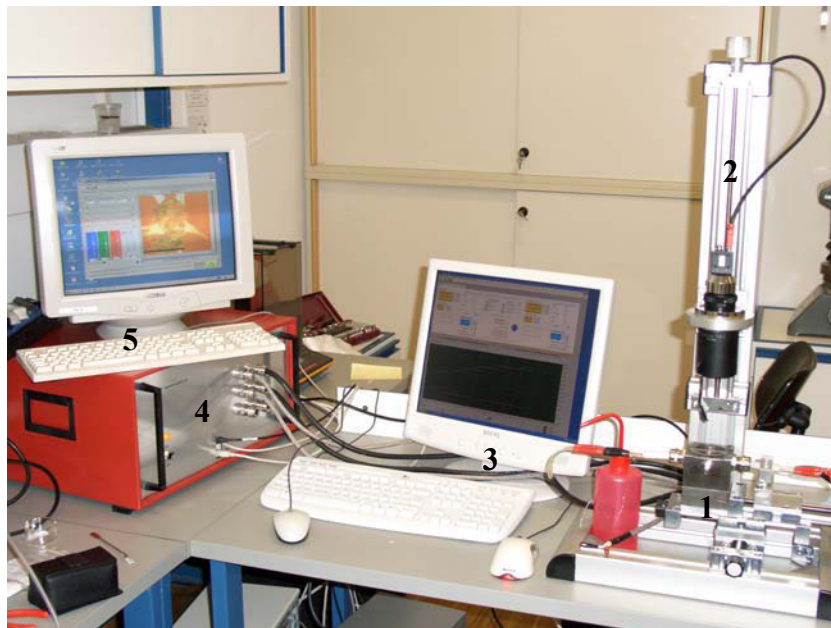
Abbildung 19: Darstellung der Hot Thermocouple Technique mit (1) Ofen inklusive Heizeinheiten, (2) Stativ inklusive Kamera und Objektiv, (3) Regel- und Steuer-PC, (4) Regeleinheit und (5) PC zur Bildaufzeichnung
