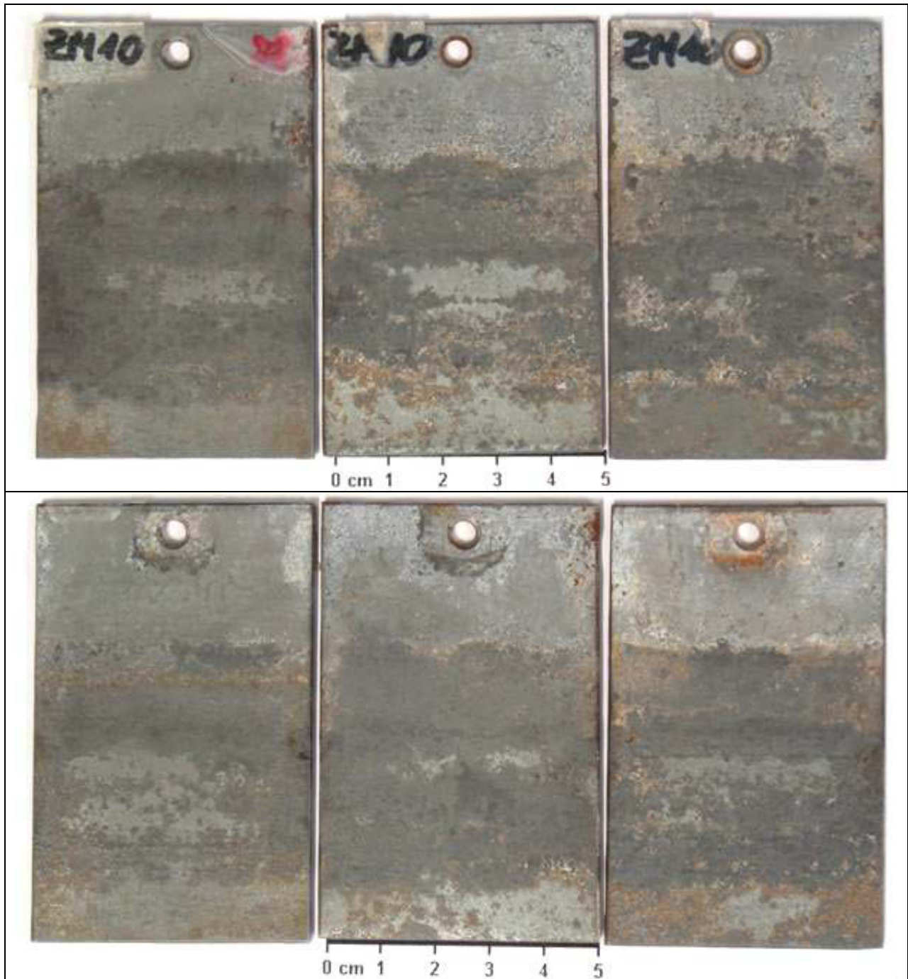
Abbildung 87: 5/5-Proben nach einem halben Jahr im SU-Test
