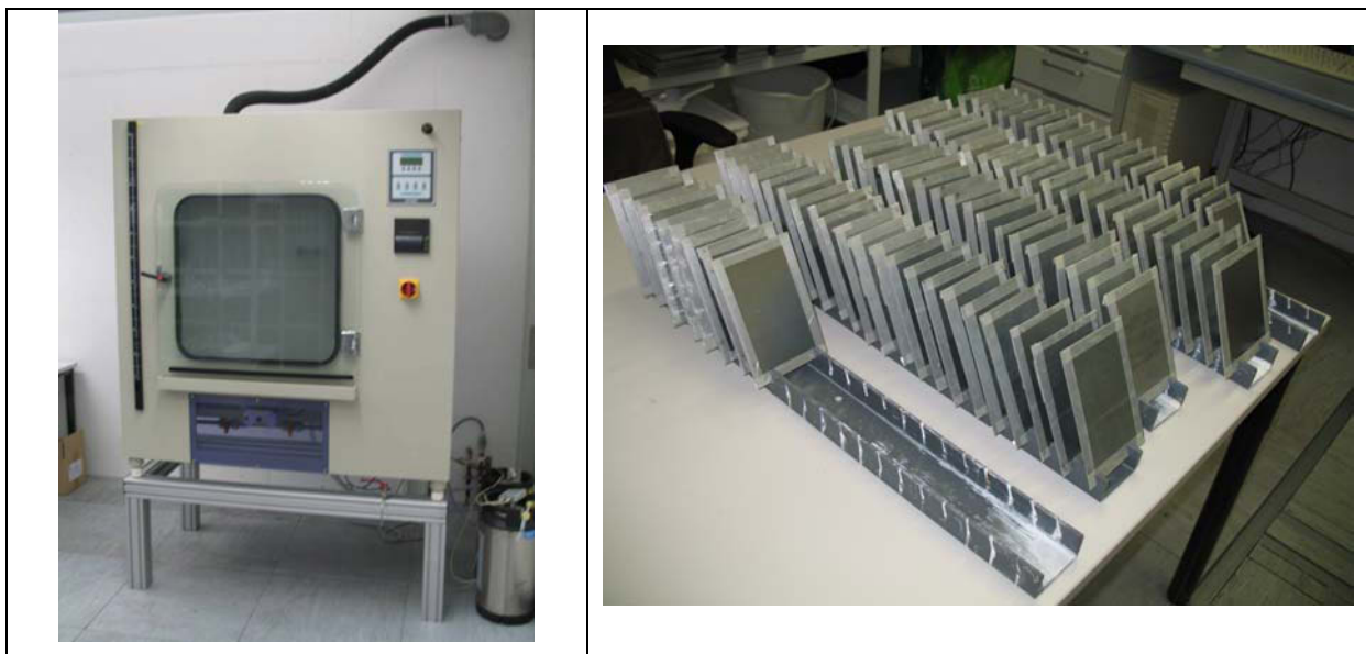
Abbildung 31: Verwendete Salzsprühkammer mit den Proben einer Testreihe
