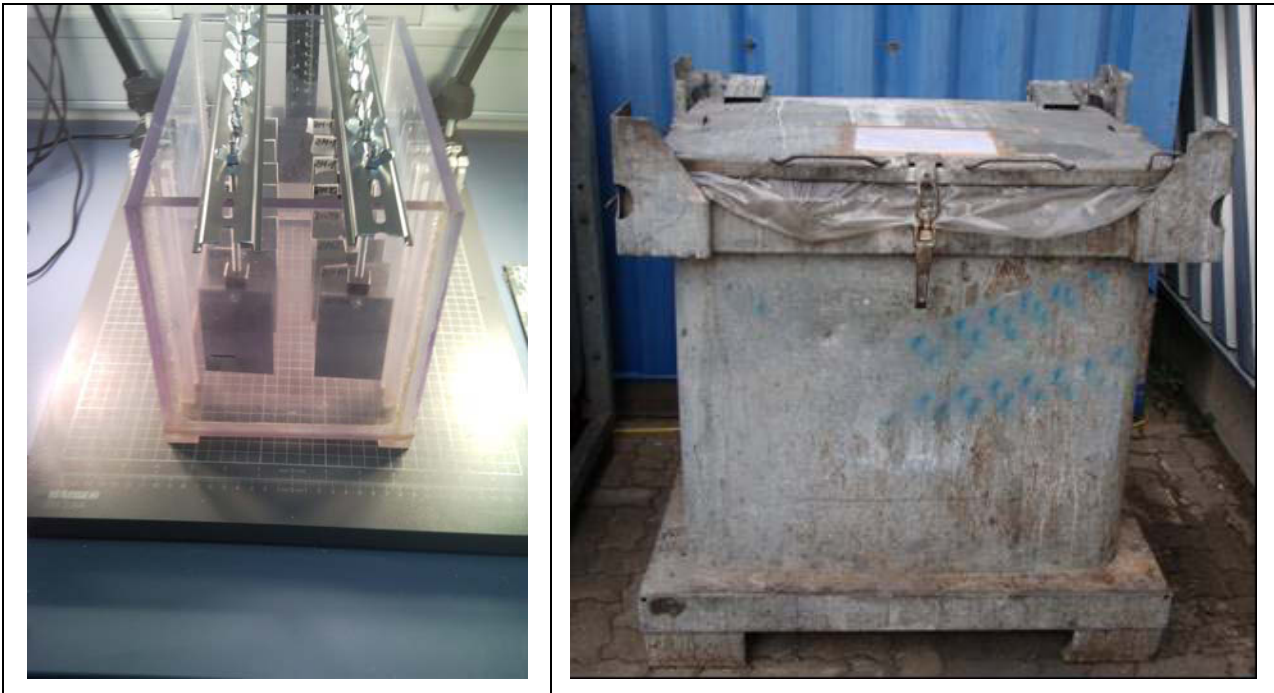
Abbildung 55: Versuchsaufbau für Korrosionstest mit Schweineurin
