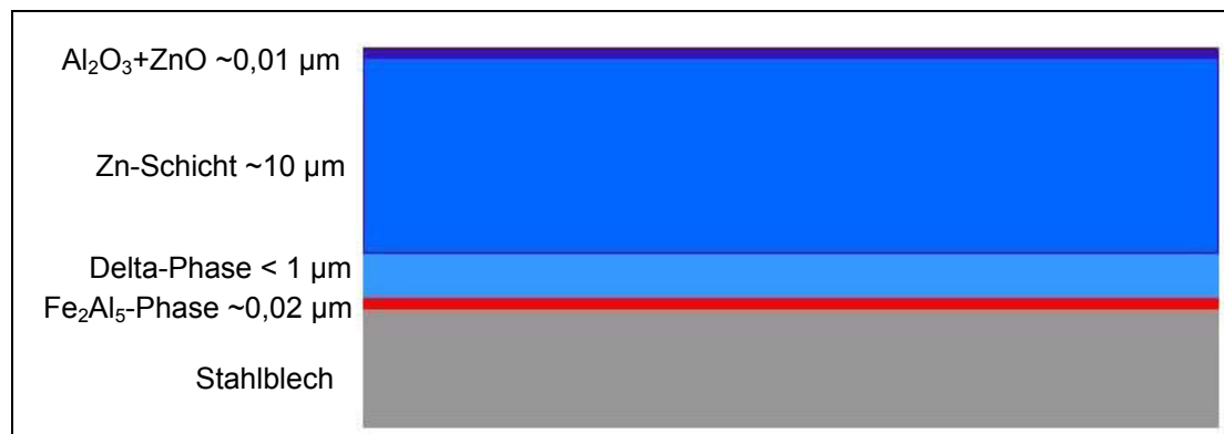
Abbildung 8: Schematische Darstellung des Aufbaus einer konventionellen Zinkschicht [20]
