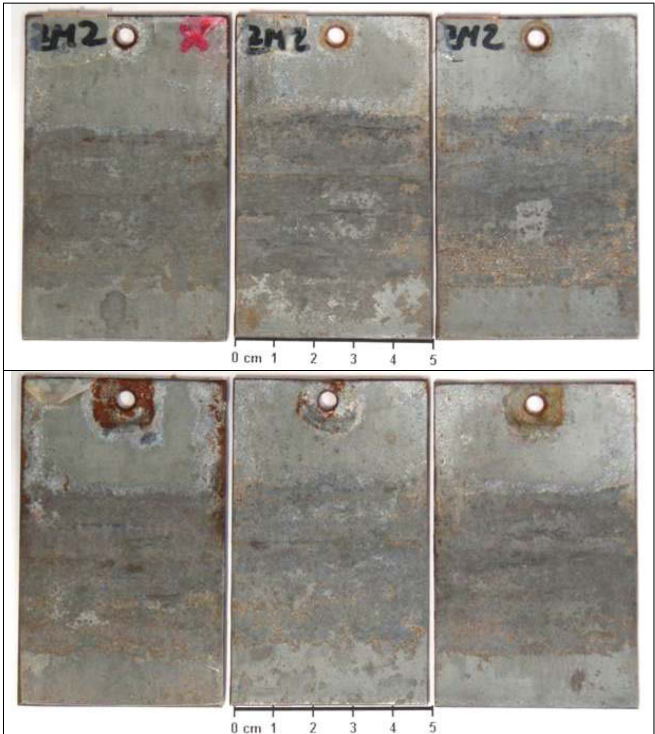
Abbildung 84: 1/1-Proben nach einem halben Jahr im SU-Test
