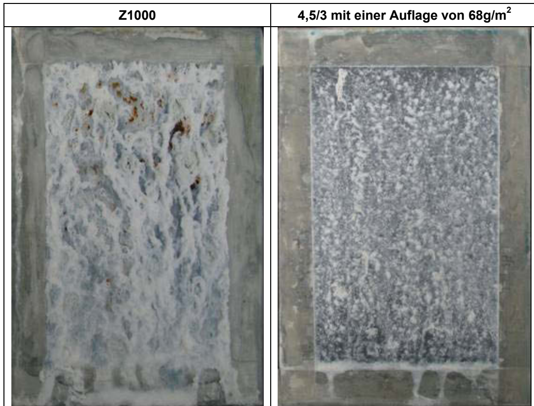
Abbildung 34: Unterschiede in der Weißrostausbildung (und Rotrostbildung) zwischen einer konventionellen Beschichtung und einer Zn-Al-Mg-Beschichtung nach 2746 Stunden im SST
