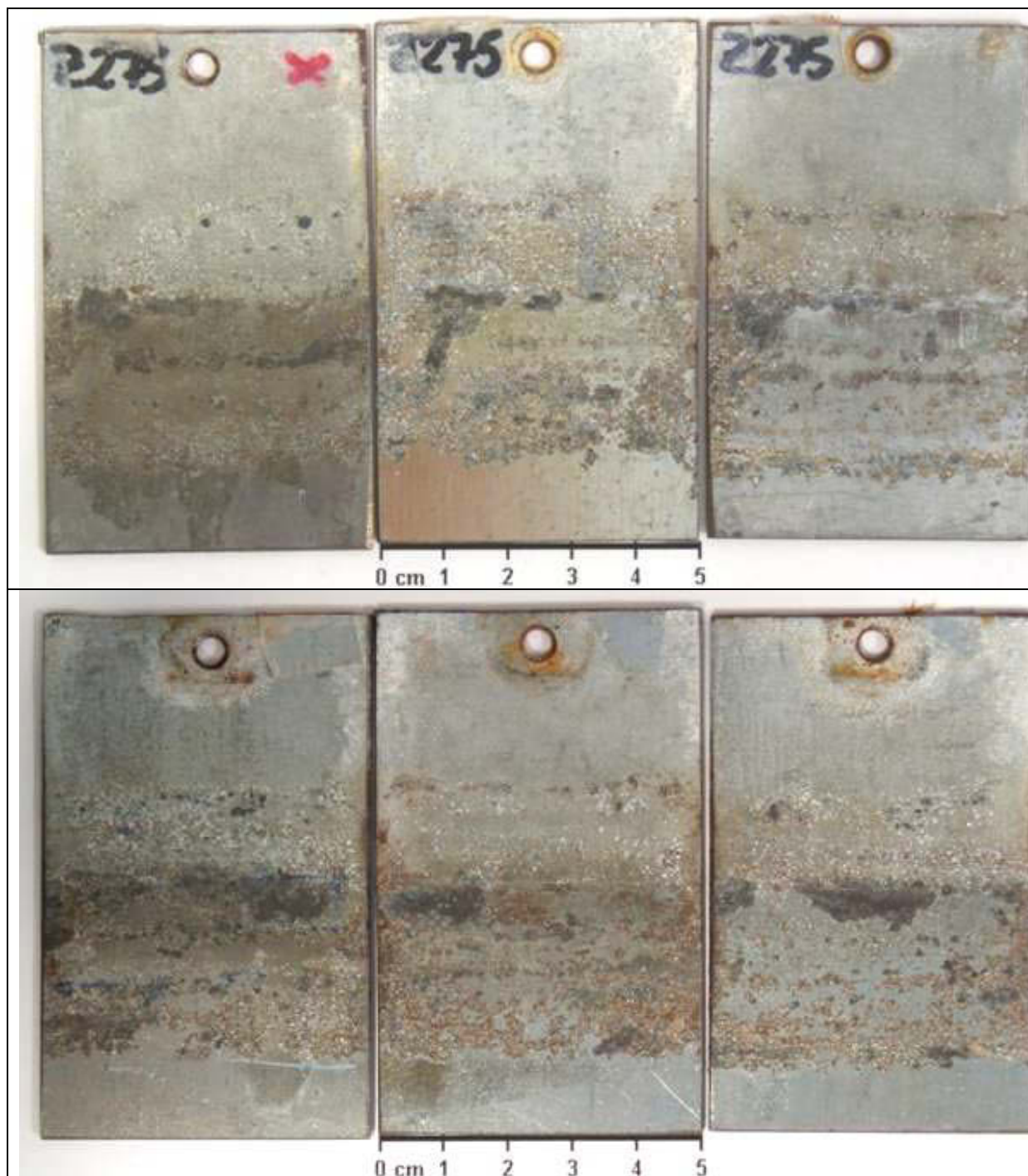
Abbildung 83: Z275-Proben nach einen halben Jahr im SU-Test
