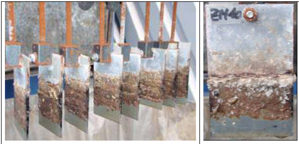
Abbildung 56: Ausbildung des organischen Belags an der Probenoberfläche
