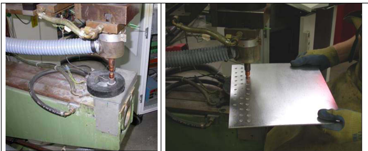
Abbildung 67: Schweißanlage und die Durchführung der Punktschweißung
