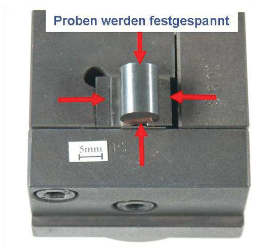
Abbildung 5.13: Einspannvorrichtung für den zyklischen Kantenstauchversuch
