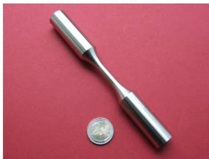
Abbildung 4.5: Prüfkörper für die Ermittlung von zyklischen mechanischen Kenngrößen
