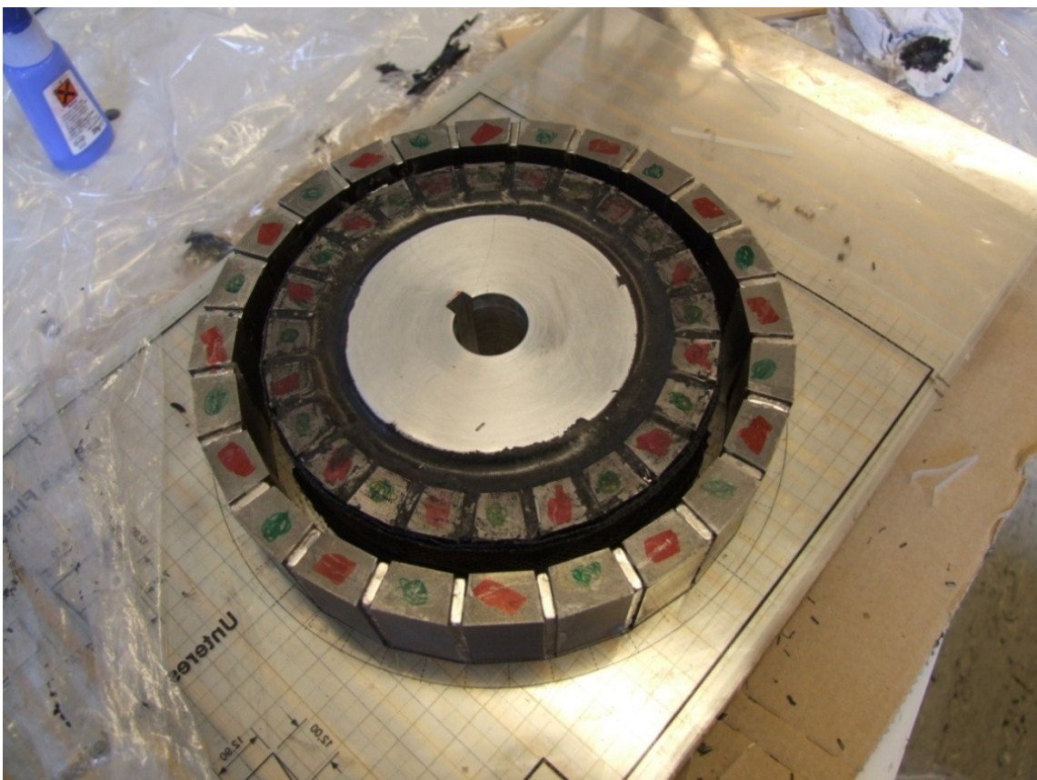
Abbildung 7.3-10: Vorbereitung zum Vergießen der äußeren Reihe
