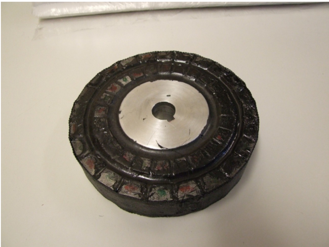
Abbildung 7.3-12: Fertig vergossener Rotor, noch nicht nachbearbeitet
