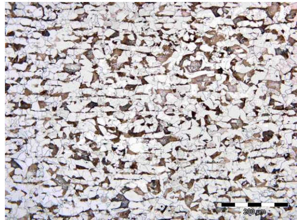
Bild 65: Schliffbild des ferritisch-perlitischen Gefüges konventionelle Route, Stahl S355JR mikrolegiert, \varphi_{global} = 0,6 \varphi_{lokal} = 1,0 Umformtemperatur: 1100^{\circ}\text{C}
