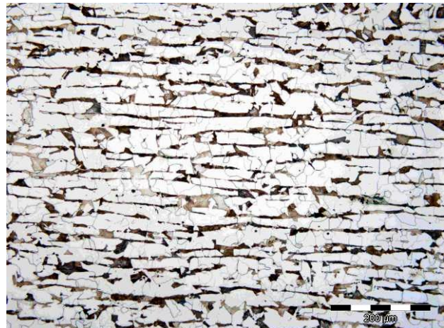
Bild 63: Schliffbild des ferritisch-perlitischen Gefüges konventionelle Route , Stahl S355JR ohne MLE, \varphi_{\text{global}} = 0,6 \varphi_{\text{lokal}} = 1,0 Umformtemperatur: 1100°C
