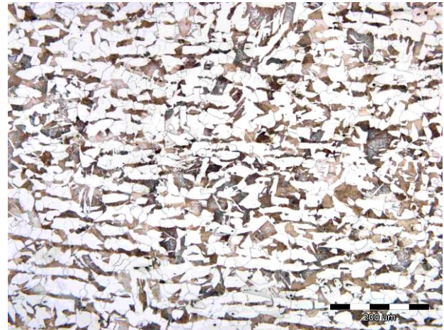
Bild 61: Schliffbild des ferritisch-perlitischen Gefüges konventionelle Route , Stahl S355JR ohne MLE, \varphi_{\text{global}} = 0,4 \varphi_{\text{lokal}} = 0,65 Umformtemperatur: 1100°C
