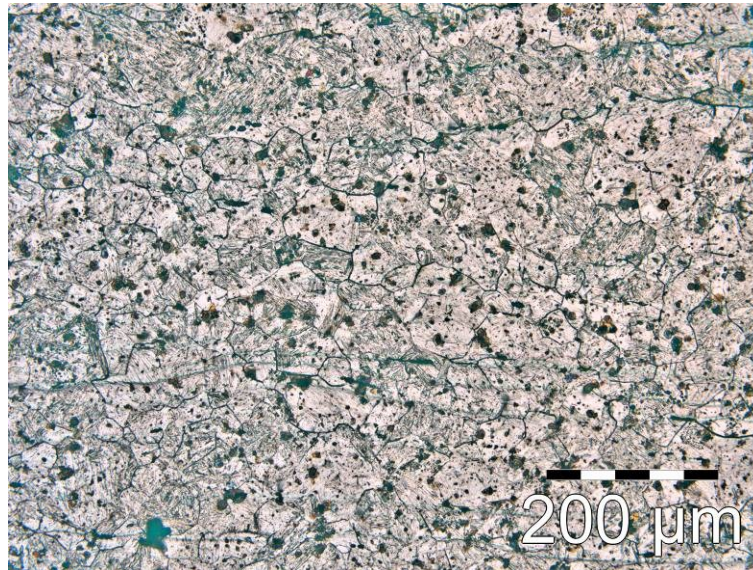
Bild 92: Schliffbild des Austenitgefüges des Nb-V-Stahls nach dem zweiten Stich, Starttemperatur: 1200°C
