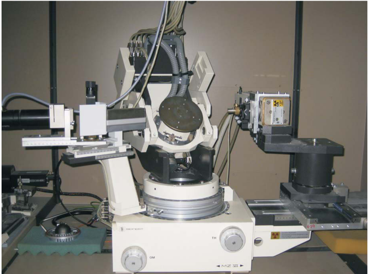
Abbildung 71: Aufbau der Röntgenanlage am Erich-Schmid-Institut zur Messung der Eigenspannungen.
