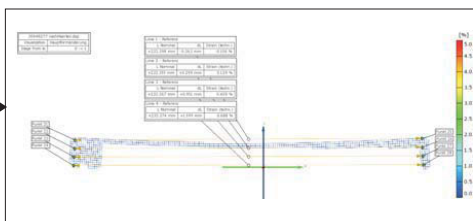
Abbildung 63: Typischer Messablauf mit Aramis ® zur Bestimmung der Säbeligkeit in Schneidlinien.
