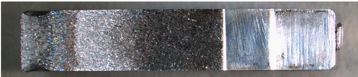
Abbildung 5.6: Stereomikroskopische Aufnahme einer CT-Proben Bruchfläche des Werkstoffes A975-27% KV geprüft in 43 Gew.-% CaCl<sub>2</sub>-Lösung bei 120°C
