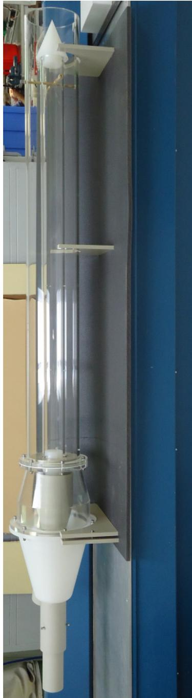
Abb. 8.9.: Feinstkornscheider während der Fertigung
