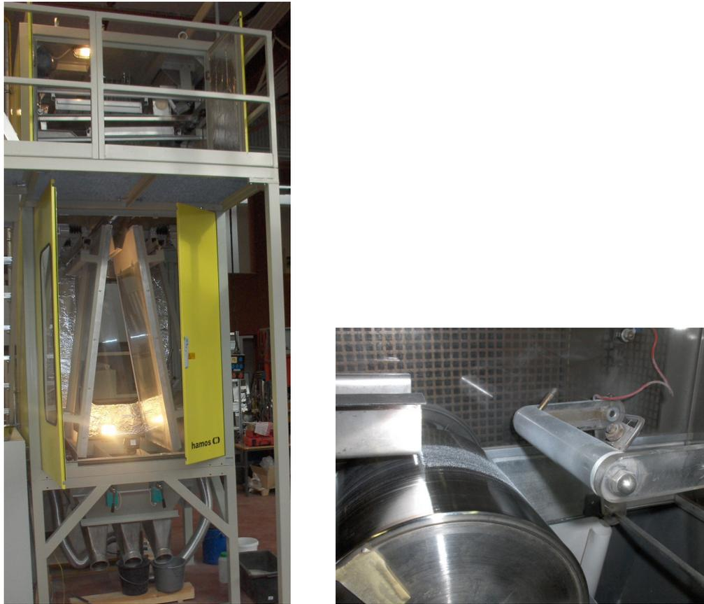
Abb. 4.1.: Elektrostatischer Kammerscheider (links) und Walzenscheider (rechts) am Lehrstuhl für Aufbereitung und Veredlung
