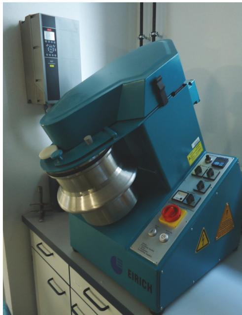
Abb. 8.11.: Eirich-Intensivmischer am Lehrstuhl für Aufbereitung und Veredlung
