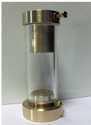
Abb. 4.6.: Messzelle zur Ermittlung der spezifischen Leitfähigkeit eines Körnerpräparates
