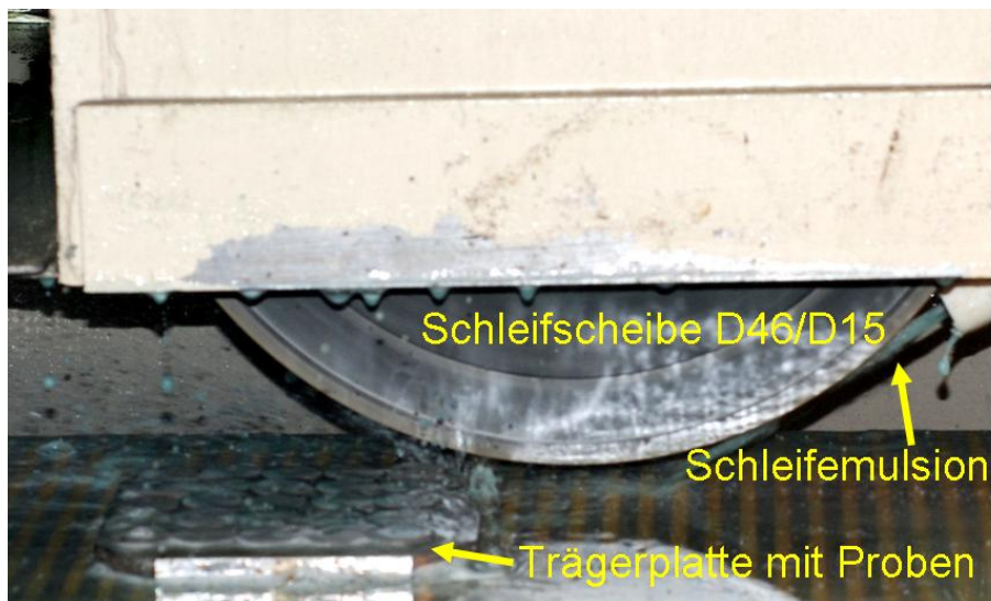
Abb. 10.3: Auf der Schleifmaschine (Fa. ELB-Schliff, Typ Juwel 20 SPS) festgespannte Trägerplatte mit 25 Proben während des Schleifvorgangs.
