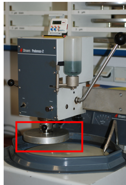
Abb. 10.4.b: Schleif- und Poliergerät Pedemax 2 mit angehobenem Probenhalter (Rechteck).
