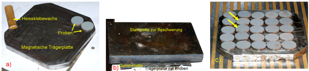
Abb. 10.1.a-c: (a) Vorgeheizte Trägerplatte mit Heißklebewachs und Proben und (b) Beschwerung der Proben auf der Trägerplatte mit einer Stahlplatte. Zwischen die Stahlplatte und die Proben wird eine ca. 3 mm dicke Gummimatte gelegt, um Unebenheiten auszugleichen. (c) Trägerplatte mit den aufgeklebten Proben nach dem Aushärten. Man kann erkennen, dass die Proben teilweise nicht exakt dieselbe Höhe haben (Pfeile). In einem Arbeitsgang können mit dieser Anordnung bis zu 25 Proben mit einem Durchmesser von 20 mm geschliffen werden.
