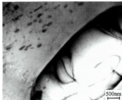
Abbildung 4: Grobes \text{Al}_7\text{Cu}_2\text{Fe} -Partikel umgeben von einer \text{Al}_{20}\text{Mn}_3\text{Cu}_2 -dispersoid-freien Zone [16]
