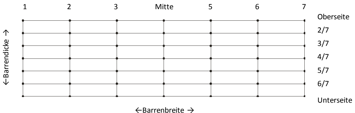
Abbildung 38: Schematische Darstellung der Probenpositionen über den Barrenquerschnitt verwendet für die nasschemische Analyse der Hauptlegierungselemente
