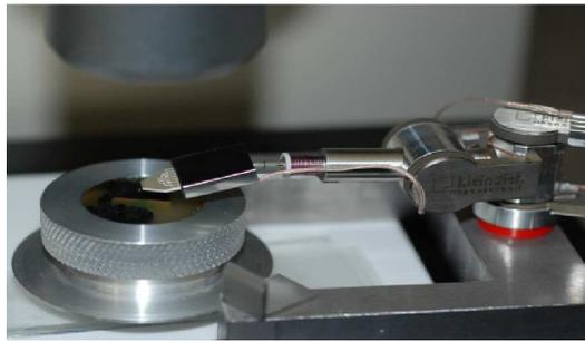
(a) Kleindiek Mikromanipulator mit Messkopf und Probe
