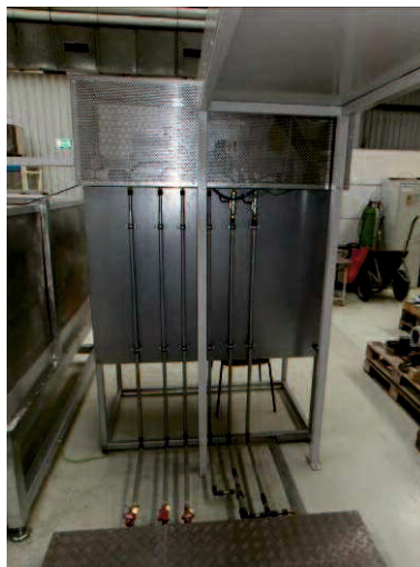
Abbildung 3: Rückansicht des Bedienfeldes. Wasserleitung mit Stellrädern (rot, unten) und Wasserwächtern (Kupfer, rechts oben).
