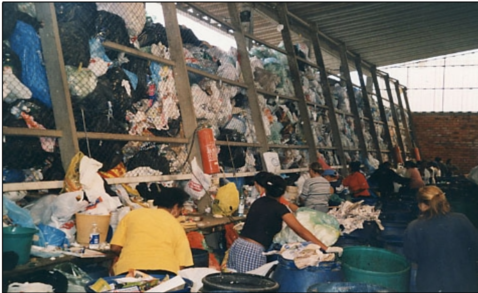
Abbildung 2.18: Sortierung des getrennt gesammelten Hausmülls nach dem System der Behälter-Trennung (Baías) (Foto: Prof. K. Lorber).
