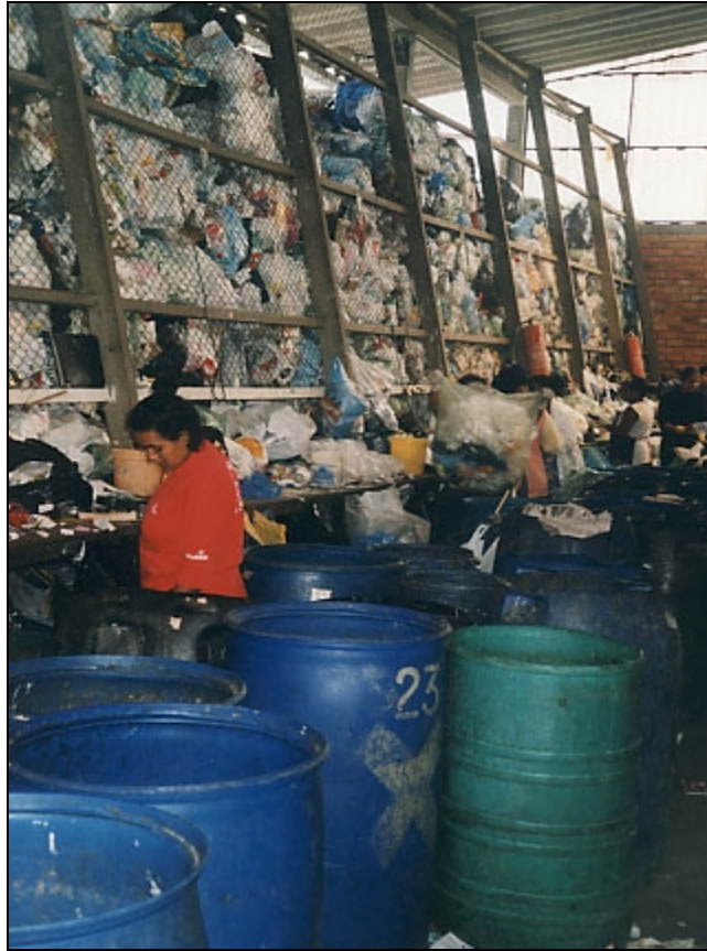
Abbildung A.17: Sortierung nach dem System der Behälter-Trennung (Baías).
