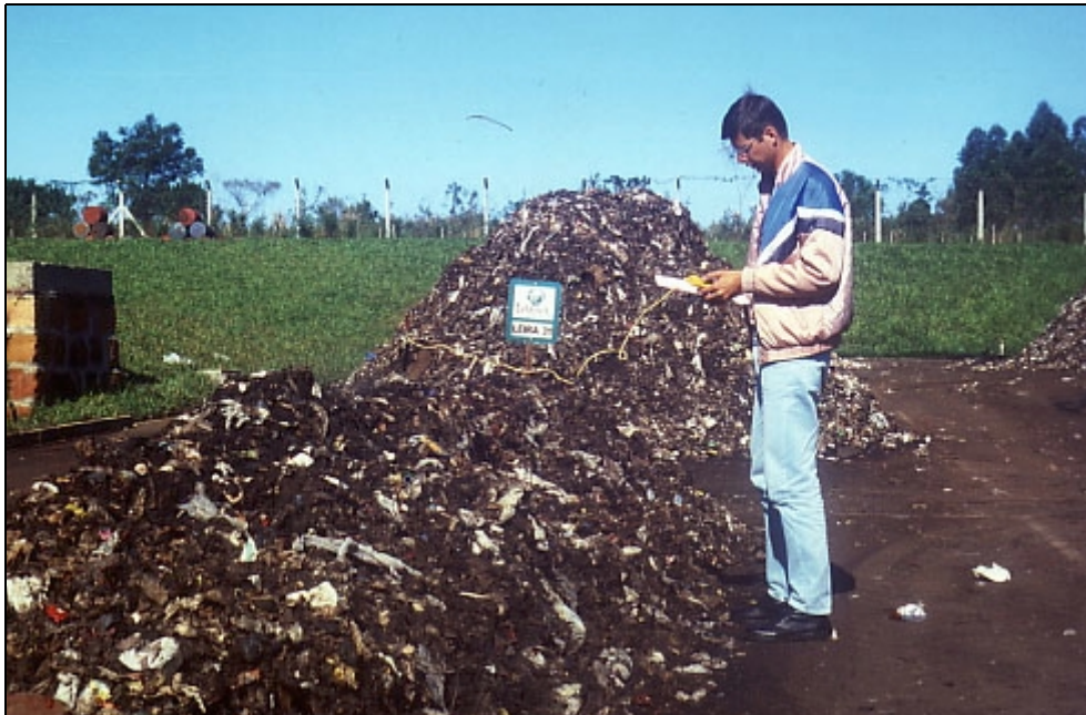
Abbildung A.5: Temperaturmessung in der Kompostmiete.
