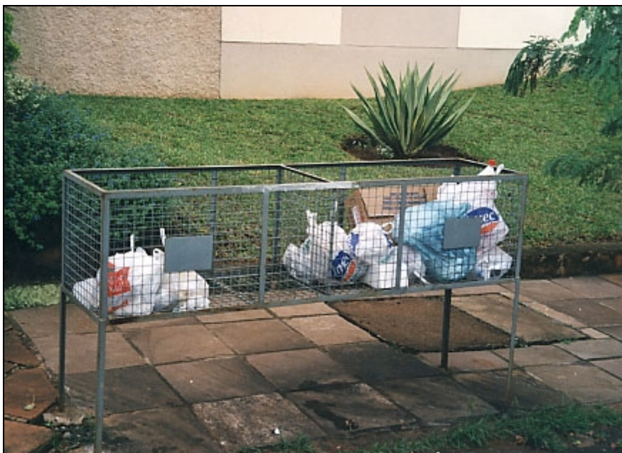
Abbildung 2.14: Drahtkörbe als Müllbehälter, die vermeiden sollen, daß Tiere im Müll stöbern (Foto: Prof. K. Lorber).
