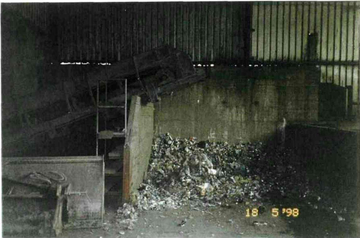
Abbildung D4: Abgetrennte Fe-Metalle nach der Zerkleinerung des Restmülls
