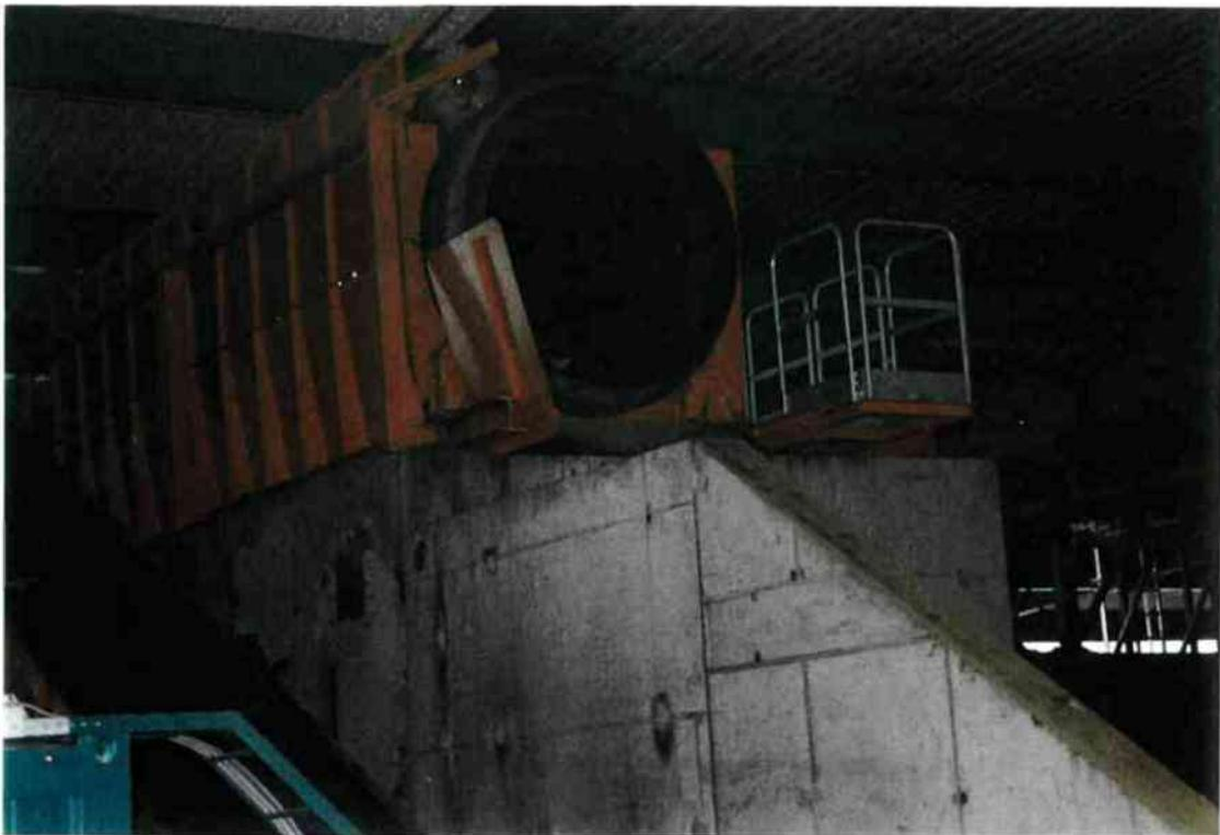
Abbildungen D12 und D13: Trommelsieb zur Absiebung von Bioabfallkompost, das im Rahmen der Versuche für die Abtrennung der heizwertreichen Materialien verwendet wurde
