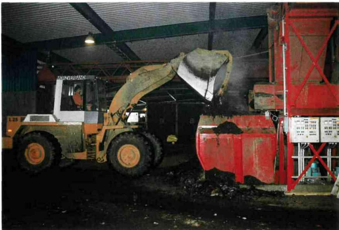
Abbildungen D6 und D7: Aufgabe von Klärschlamm und Restmüll < 80 mm für die Homogenisierung mittels Chargenmischer vor der Intensivrotte
