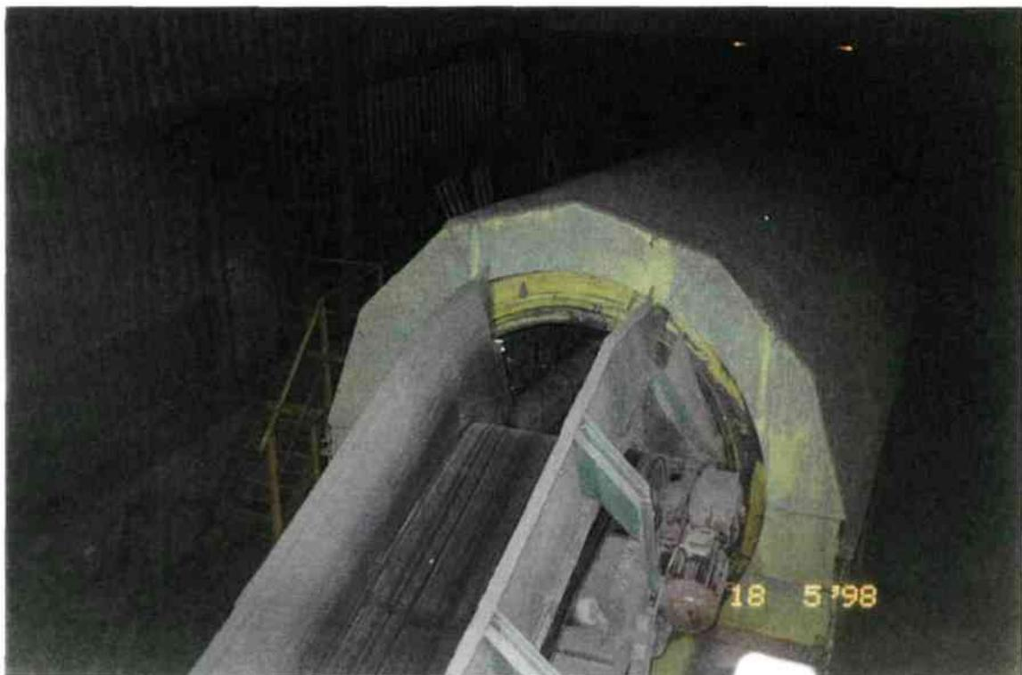
Abbildung D5: Absiebung des zerkleinerten Restmülls mittels Trommelsieb bei 80 mm
