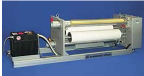
Abbildung 3-3 Für die Oberflächenaktivierung verwendete Corona Anlage im Labormaßstab
