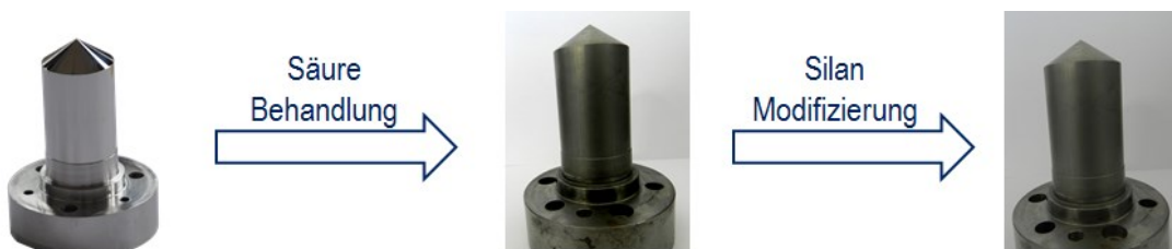
Abbildung 5-63 Werkzeugeinsatz (a.) vor und (b.) nach der \text{HNO}_3 -Aktivierung und (c.) nach der PFOS Modifizierung
