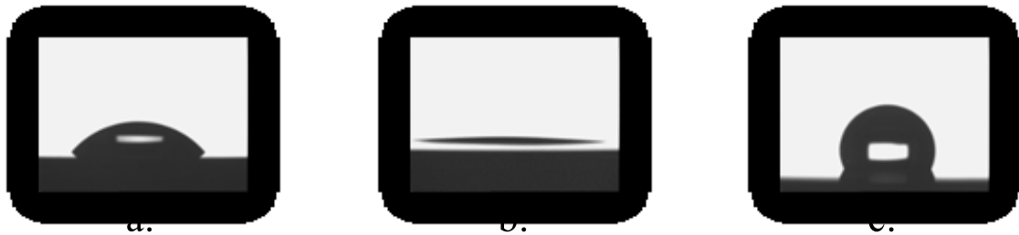
Abbildung 5-38 Wassertropfen auf der Stahloberfläche (a.) vor und (b.) nach Corona-Aktivierung und (c.) mit F-8 modifizierter Stahloberfläche
