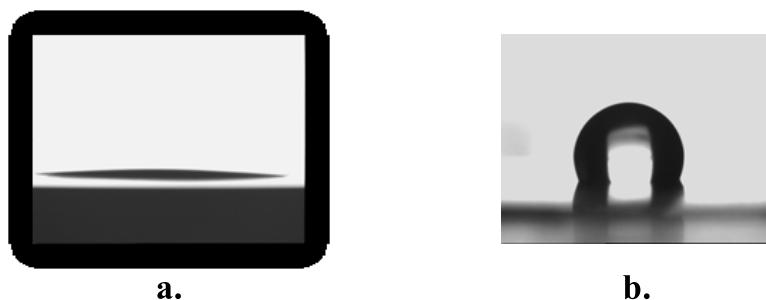
Abbildung 5-55 Wasserkontaktwinkel auf der (a.) Corona aktivierten Stahloberfläche und (b.) nach der Modifizierung mit F-17
