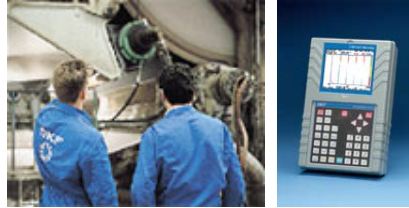
Slika 1. Prikaz detekcije debalansa rotirajućeg vratila na netipičnom proizvodnom agregatu sa rešenjem problema
